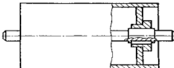
Рисунок 2.2 – Приклад зображення зварної складальної одиниці на складальному кресленні виробу
