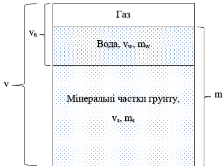
Рисунок 1.4 – Модель ґрунту: v – об’єм зразка ґрунту; v_s – об’єм мінеральних часток ґрунту; v_n – об’єм пір; v_w – об’єм води в порах; m – маса зразка ґрунту; m_s – маса часток ґрунту(скелета); m_w – маса води
