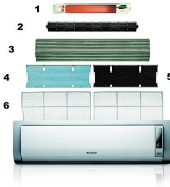
Рисунок 13.2 – Система очистки повітря в кондиціонерах: 1 – іонізатор; 2 – вентилятор внутрішнього блоку; 3 – теплообмінник Silver Nano, 4 – антиалергічний фільтр, 5 – дезодоруючий фільтр; 6 – електростатичний фільтр
