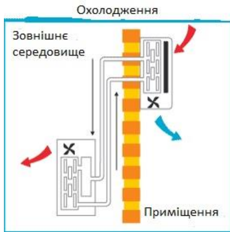
Рисунок 7.2 – Робота кондиціонера в режимі охолодження
