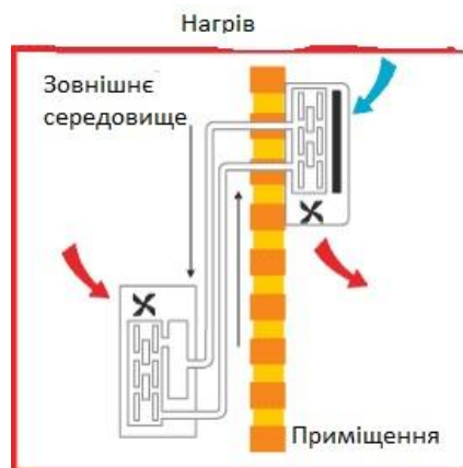
Рисунок 7.3 – Робота кондиціонера в режимі обігріву
