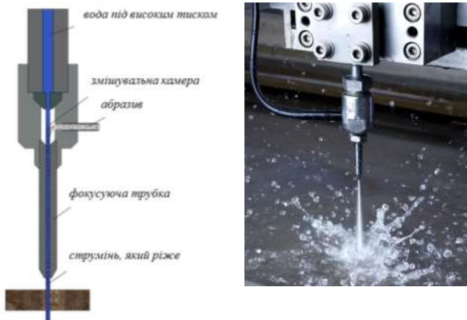
Рисунок 9.8 – Схема пристрою для гідрорізання
