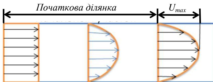
Рисунок 5.3 – Зміна епюр швидкостей у ламінарному потоці
