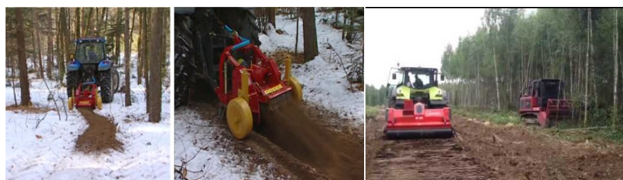
Рисунок 7.8 – Машини для зрізання та згортання чагарників та дрібнолісся: а – мульчери; б – робота роватора; в – мотокущоріз
