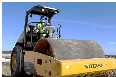
Рисунок 4.73 – Машини для укочування чорного щебеня: а, б – пневмоколісний коток; в – коток з металевим вальцем, покритим гумовою оболонкою
