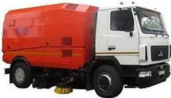
Рисунок 4.3 – Підмітально-прибиральна машина AG326 МАЗ
