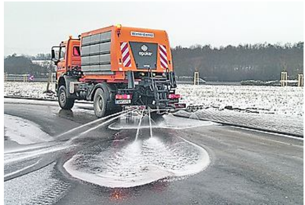
Рисунок 4.32 – Розподіл реагентів: а – твердих; б – рідких
