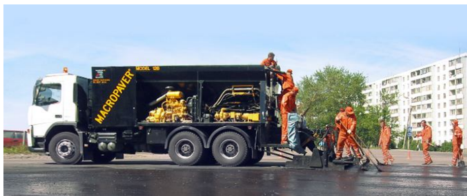
Рисунок 4.76 – Машини для нанесення захисного шару типу «Сларрі Сіл»: а – установка M310 компанії «Bergkamp»; б – установка RoadSaver III G компанії «Rayner Equipment Systems» (RES); в – установка Macropaver 12B компанії «Valley Slurry Seal» (VSS)
