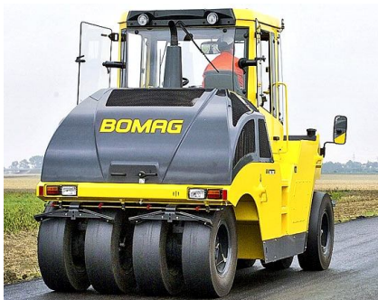
Рисунок 4.73 – Машини для укочування чорного щебеня: а, б – пневмоколісний коток; в – коток з металевим вальцем, покритим гумовою оболонкою
