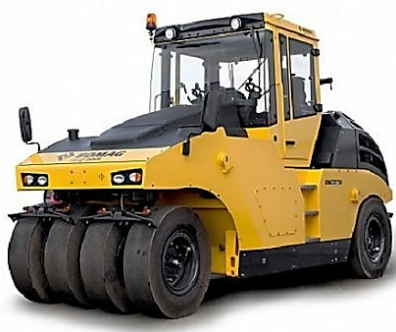
Рисунок 4.73 – Машини для укочування чорного щебеня: а, б – пневмоколісний коток; в – коток з металевим вальцем, покритим гумовою оболонкою
