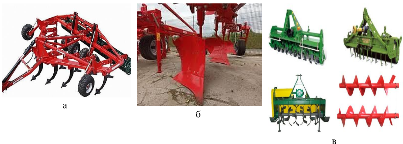
Рисунок 7.11 – Пристрої для робіт щодо покращення якостей ґрунту: а – навісний розпушувач; б – плантажний плуг; в – фрези
