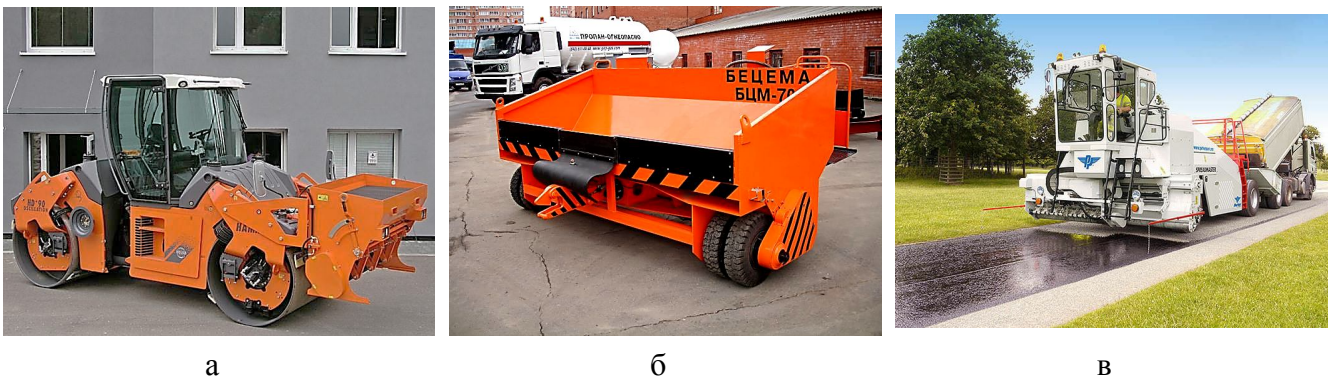
Рисунок 4.72 – Види щебенерозподілювачів: а – навісний для котка; б – причепний; в – самохідний
