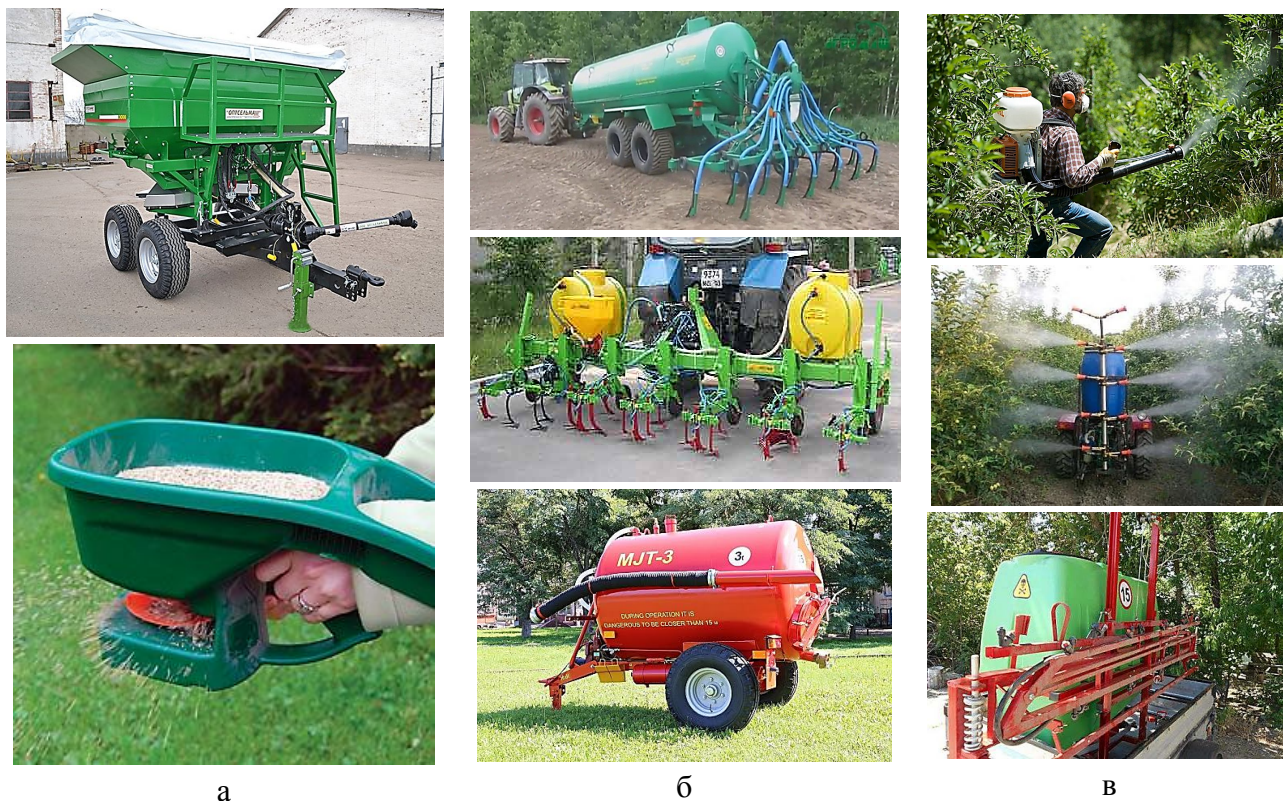
Рисунок 7.52 – Пристосування та механізми для внесення різних видів добрив: а – причіпний двовісний розкидач добрив; б – машини для внесення рідких органічних добрив; в – спеціальні обприскувачі
