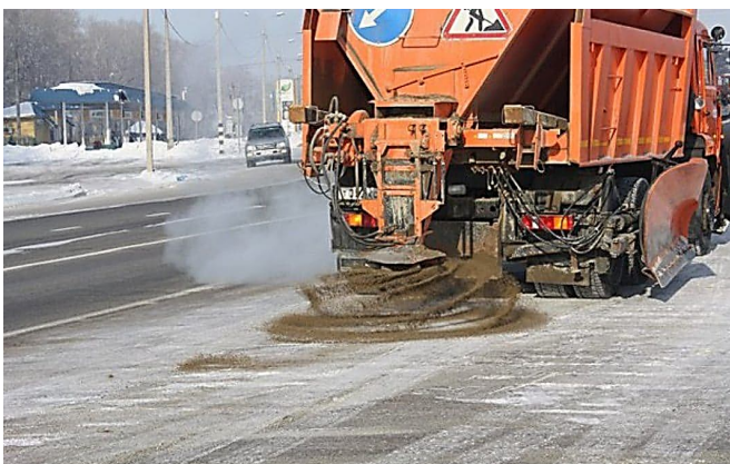
Рисунок 4.32 – Розподіл реагентів: а – твердих; б – рідких
