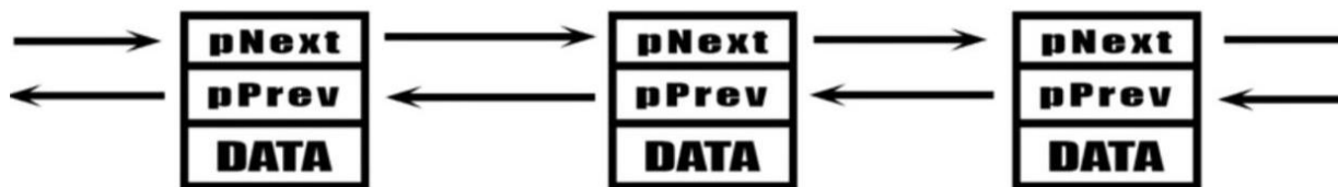
Рисунок 1.33 – Схема двозв'язкового списку
