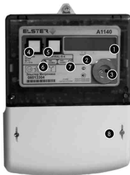
Рисунок 13 – Загальний вид лічильника Альфа А1140: 1 – РКИ; 2 – знімний щиток; 3 – оптичний порт; 4 – кнопка RESET; 5 – кнопка ALT; 6 – світлодіод реактивної енергії; 7 – світлодіод активної енергії
