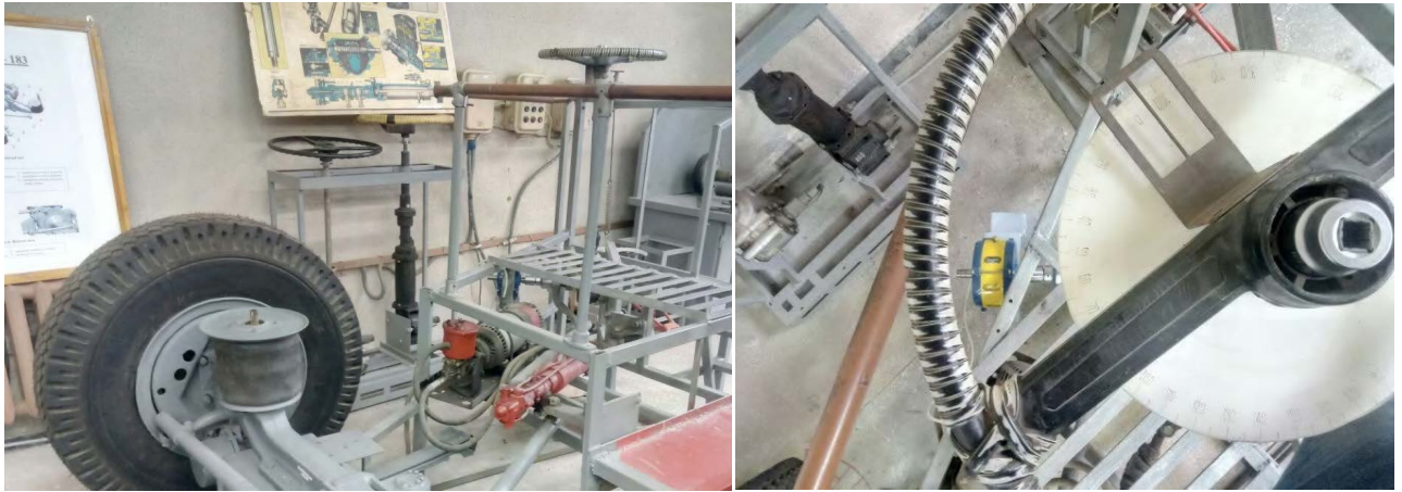
Рисунок 2.2 – Стенд для дослідження системи рульового керування тролейбусу з гідропідсилювачем
