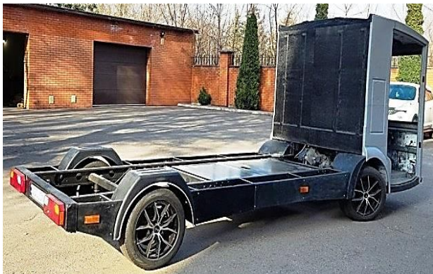
Рисунок 1 Перші дослідні зразки електромобілів категорії N1: а) – моделі "Coolon"; б) – моделі EN31 "Карпати"
