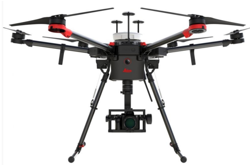
Рисунок 1.7 – Гексакоптер Leica Aibot [19]
