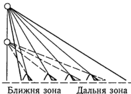
Рисунок 2.5 – Радіотіні як функція висоти польоту і кута візування [1]
