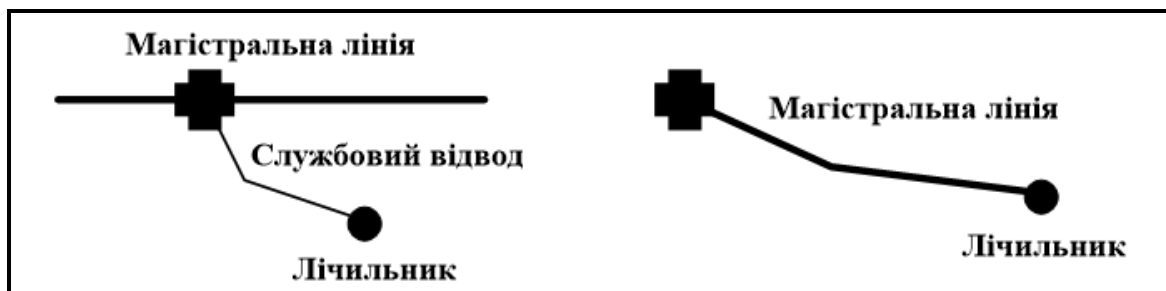
Рисунок 8.12 – Приклад для правила «Ребро-з'єднання»
