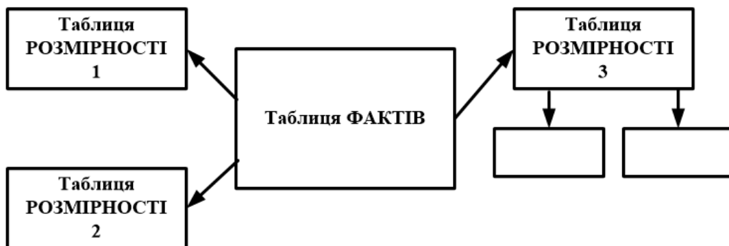
Рисунок 9.9 – Схема моделі даних «зірка»
