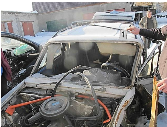
Рисунок 3.121 – Загальний (а) та вузловий (б) вигляди деформації даху автомобіля ВАЗ-2102
