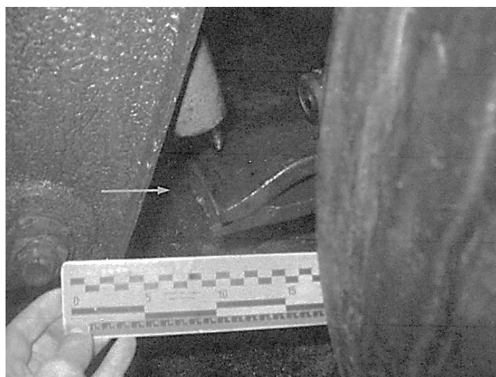
Рисунок 3.57 – Детальний вигляд пошкодження листів ресори підвіски лівих коліс напівпричепа Trailor S383EL
