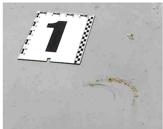
Рисунок 3.64 – Вузловий (а) та детальний (б) вигляди спереду пошкодження у вигляді деформації дугоподібної форми в середній частині капота
