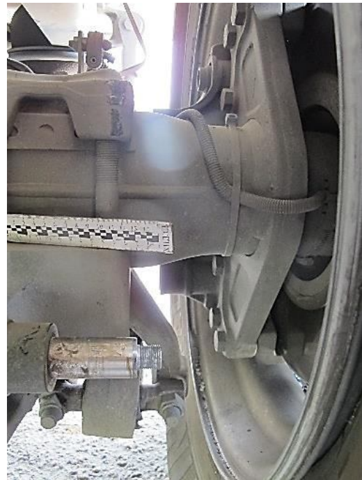
Рисунок В.47 – Детальний вигляд нижнього вузла для кріплення амортизатора підвіски лівого заднього подвійного колеса автомобіля MAN TGM
