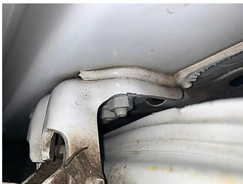
Рисунок Ж.12 – Деформація петлі верхньої двері передньої правої
