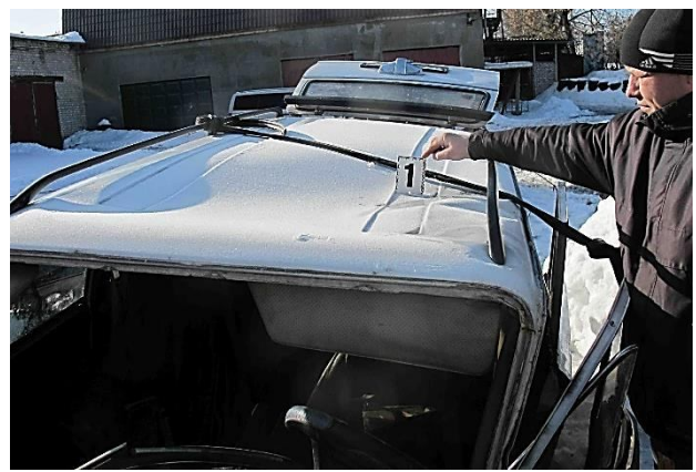
Рисунок 3.121 – Загальний (а) та вузловий (б) вигляди деформації даху автомобіля ВАЗ-2102
