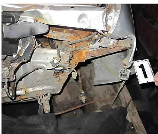
Рисунок 3.101 – Вузлові вигляди спереду (а) та спереду зліва (б) пошкоджень у районі передньої частини лівого крила
