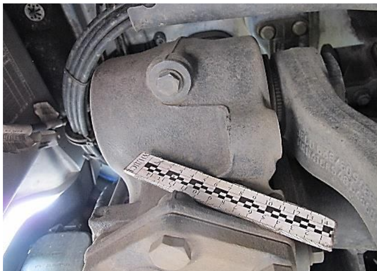
Рисунок В.6 – Детальний вигляд картера рульового механізму автомобіля MAN TGM та кріплення сошки до нього
