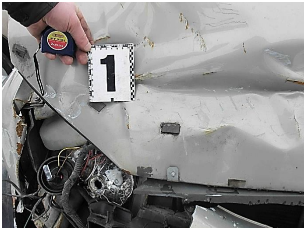
Рисунок 3.137 – Детальні вигляди пошкоджень та нашарувань речовини білого кольору в правій (а) та лівій частинах (б) деформацій в передній частині капота
