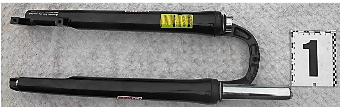
Рисунок 3.76 – Загальний вигляд ззаду передньої вилки велосипеда із зруйнованими амортизаторами
