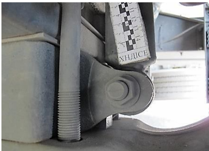
Рисунок В.31 – Детальний вигляд нижнього кріплення амортизатора лівого переднього колеса автомобіля MAN TGM
