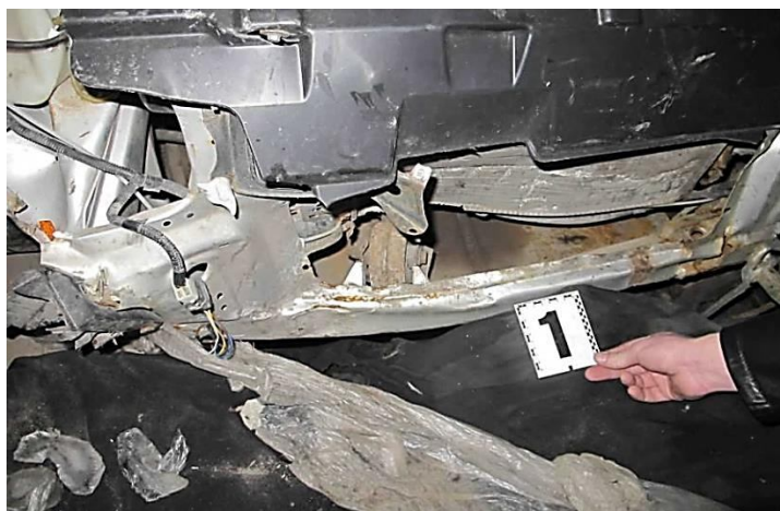
Рисунок 3.100 – Вузловий вигляд пошкодження нижньої частини панелі рамки радіатора
