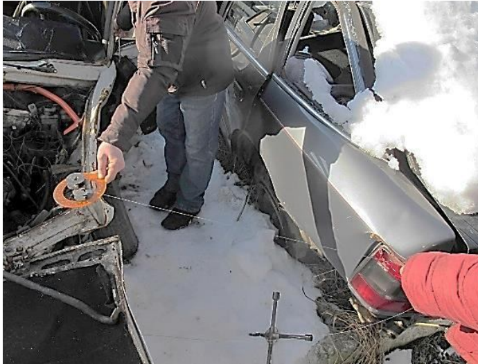
Рисунок 3.146 – Загальні вигляди встановлення величини кута за пошкодженнями на автомобілі ВАЗ-2102 з урахуванням пошкоджень на автомобілі ВАЗ-11183 (з урахуванням взаємно контактуючих пар на них)
