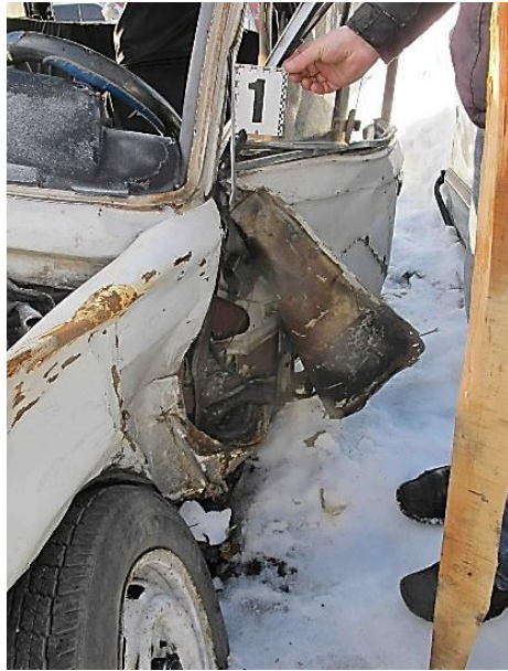
Рисунок 3.150 – Загальний вигляд зриву зовнішньої панелі лівих передніх дверцят
