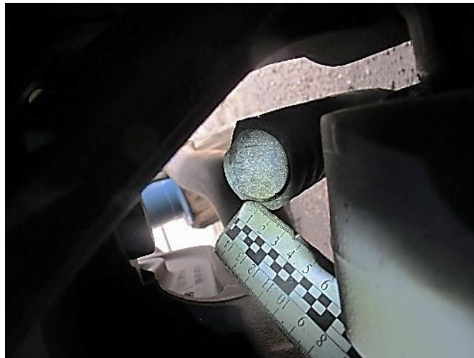
Рисунок В.54 – Детальний вигляд поверхні зламу зруйнованого повздовжнього важеля підвіски лівого заднього подвійного колеса автомобіля MAN TGM
