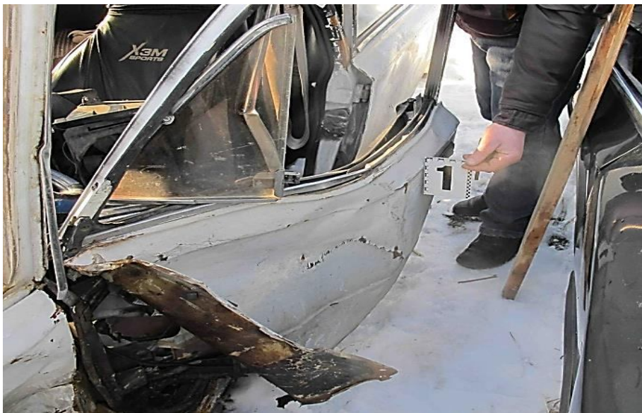
Рисунок 3.124 – Вузловий вигляд вигину назовні в середній частині лівих передніх дверцят
