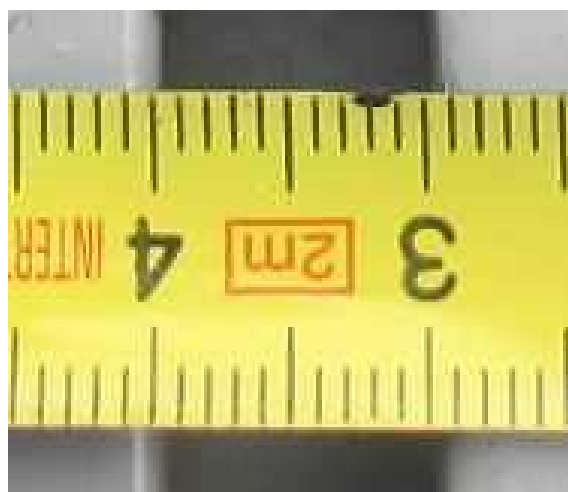
Рисунок 3.67 – Вузловий (а) та детальний (б) вигляди ширини зазору між кромкою капота та верхньою частиною правого переднього крила (на рівні правого заднього кута капота)
