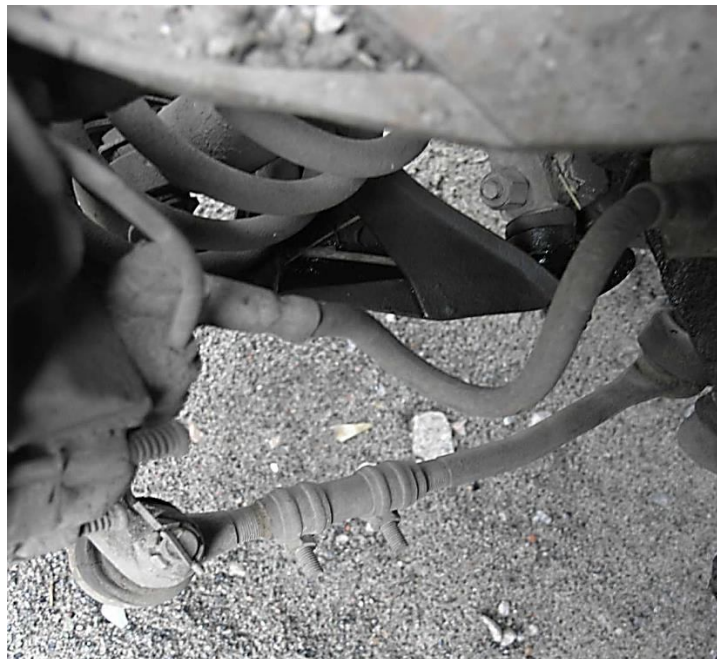
Рисунок 3.48 – Детальний вигляд надійного з'єднання лівої бічної тяги стяжним хомутом регулювальної муфти
