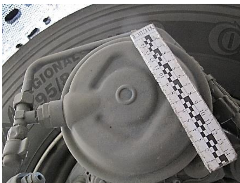
Рисунок В.17 – Детальний вигляд гальмівної пневмокамери лівого переднього колеса автомобіля MAN TGM
