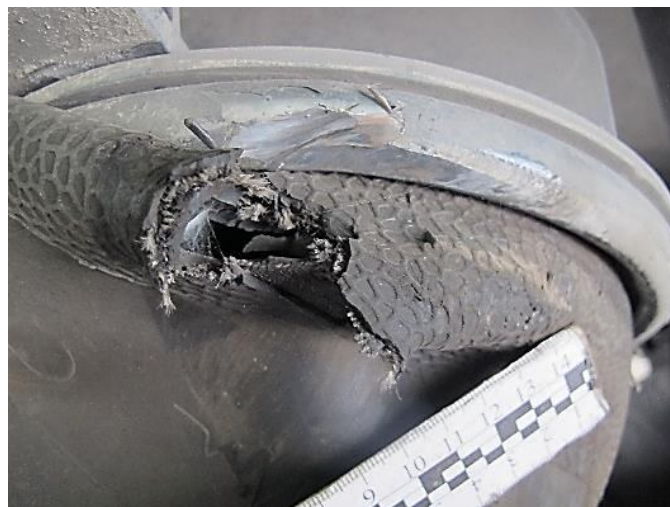
Рисунок В.52 – Детальний вигляд наскрізного пошкодження на пневмопружині підвіски лівого заднього подвійного колеса автомобіля MAN TGM
