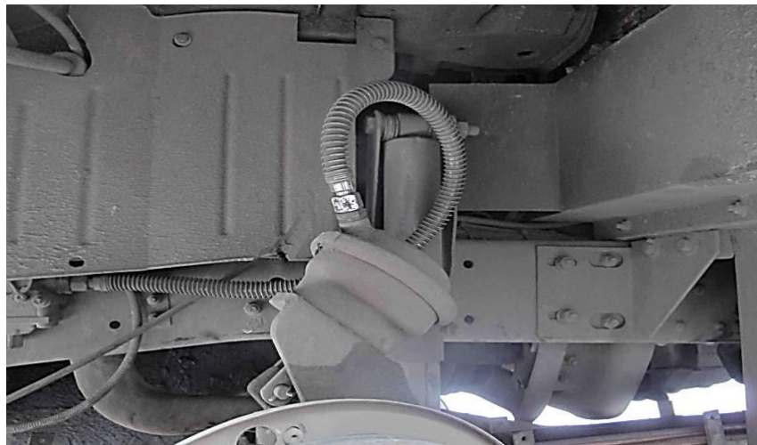
Рисунок Г.14 – Вузловий вигляд дійсного стану камери гальмівного механізму лівого переднього колеса
