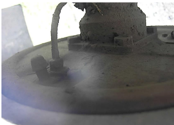
Рисунок 3.41 – Детальний вигляд зверху відсутності підтікань гальмівної рідини в місці кріплення штуцера гальмівного механізму правого заднього колеса
