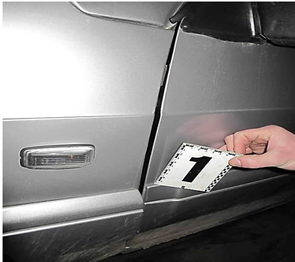
Рисунок 3.103 – Вузловий (а) та детальний (б) вигляди збільшення зазору між задньою частиною лівого крила та лівими дверцятами
