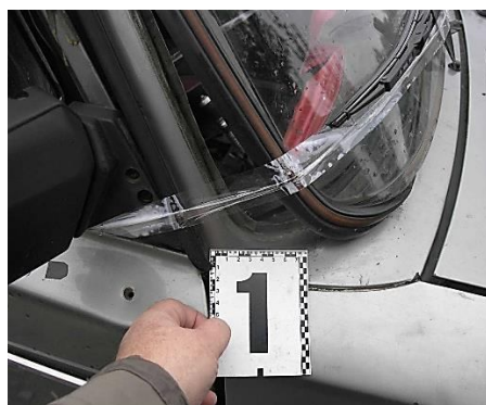
Рисунок 3.32 – Детальний вигляд зліва пошкодженого кріплення лобового скла автомобіля в районі його лівого верхнього кута
