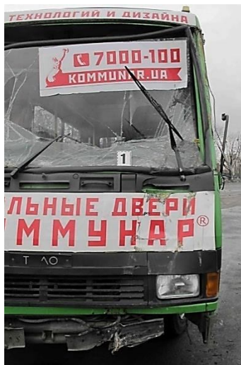
Рисунок Г.4 – Загальний (а) та вузловий (б) вигляди пошкоджень у лівій передній частині кузова автобуса
