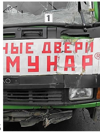
Рисунок Г.4 – Загальний (а) та вузловий (б) вигляди пошкоджень у лівій передній частині кузова автобуса
