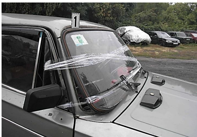
Рисунок 3.30 – Вузловий вигляд справа пошкодженого кріплення лобового скла автомобіля
