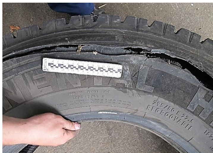
Рисунок В.77 – Детальний вигляд наскрізного пошкодження «Г» на внутрішньому боці шини зовнішнього колеса лівого заднього подвійного колеса автомобіля MAN TGM
