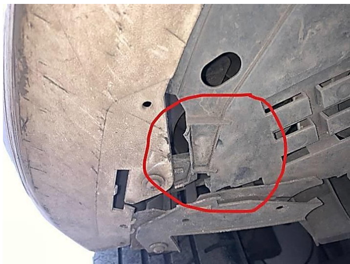
Рисунок Ж.13 – Пошкодження захисту нижнього
