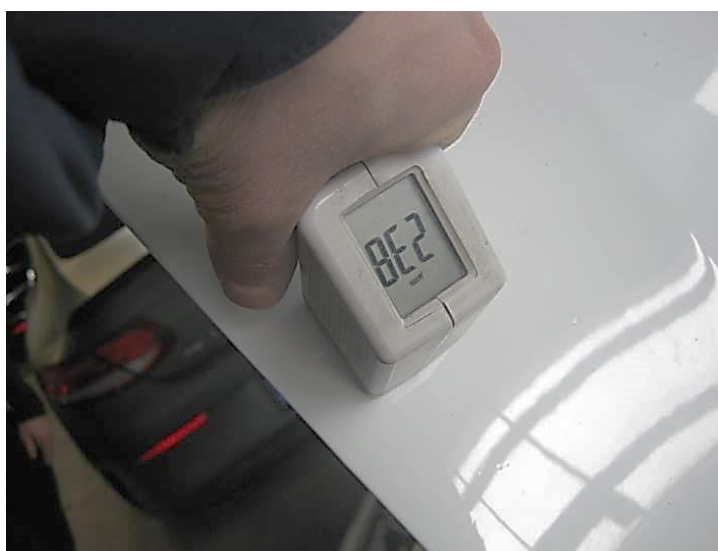
Рисунок Ж.21 – Сліди відновлювального ремонту капота
