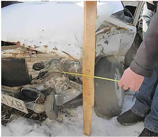
Рисунок 3.120 – Вузлові вигляди замірів глибини увігнутостей в районі лівого переднього крила автомобіля ВАЗ-2102
