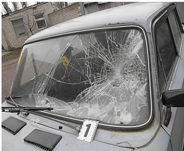
Рисунок 3.69 – Загальний (а) та детальний (б) вигляди руйнування лобового скла
