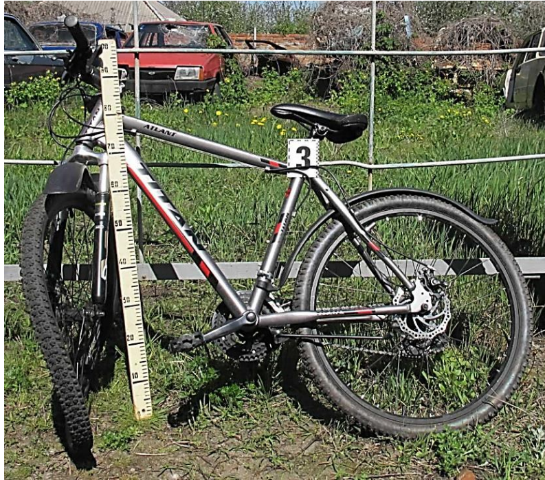
Рисунок 3.5 – Загальний та детальний вигляди деформацій ободу переднього колеса та рульової колонки (на рівні нижньої частини рульового стакана рами) у напрямку справа наліво
