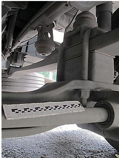
Рисунок В.40 – Детальний вигляд кріплення ресори підвіски лівого переднього колеса автомобіля MAN TGM до лівої частини балки передньої підвіски
