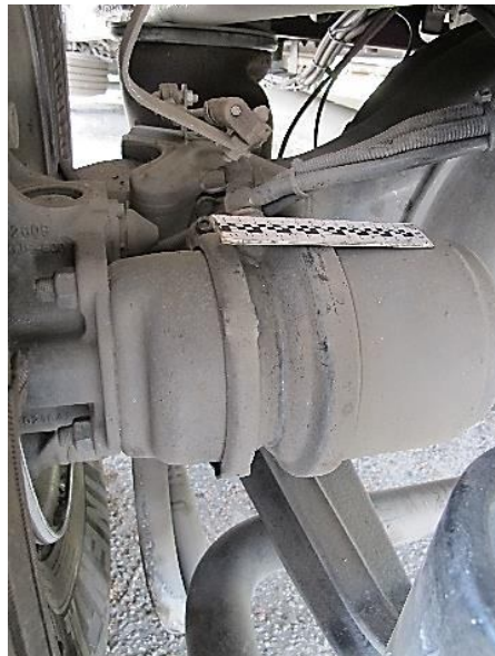
Рисунок В.22 – Детальний вигляд гальмівної пневмокамери з пружинним енергоакумулятором лівого заднього колеса автомобіля MAN TGM
