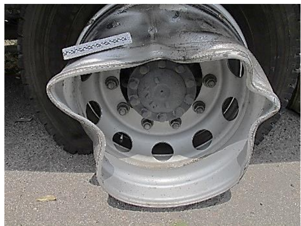
Рисунок В.59 – Детальний вигляд деформацій зовнішньої закраїни ободу зовнішнього колеса лівого заднього подвійного колеса автомобіля MAN TGM у вигляді загину металу в радіальному напрямку до центра колеса
