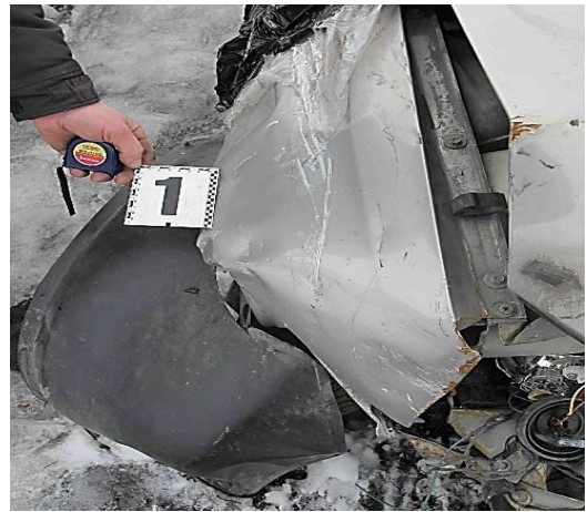
Рисунок 3.152 – Детальні вигляди збоку (а) та спереду зверху (б) пошкоджень на правому передньому крилі
