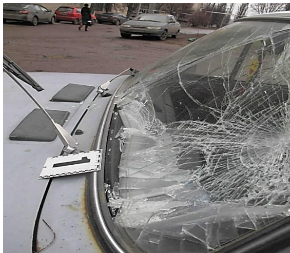
Рисунок 3.69 – Загальний (а) та детальний (б) вигляди руйнування лобового скла
