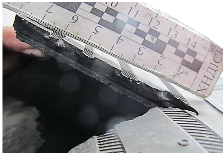
Рисунок В.76 – Детальний вигляд торців наскрізного пошкодження «Г» на внутрішньому боці шини зовнішнього колеса лівого заднього подвійного колеса автомобіля MAN TGM
