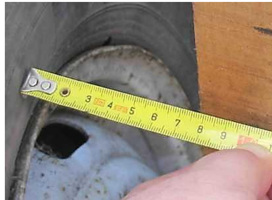
Рисунок 3.119 – Вузловий (а) та детальний (б) вигляди замірів зміщення верхньої частини лівого переднього колеса автомобіля ВАЗ-2102
