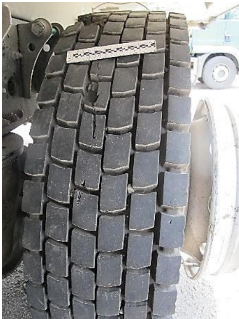
Рисунок В.56 – Детальний вигляд пошкодження протекторної частини внутрішнього колеса лівого заднього подвійного колеса автомобіля MAN TGM у вигляді виривання гуми
