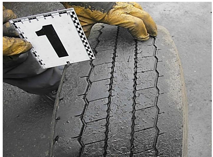
Рисунок Г.19 – Загальний (а) та детальний (б) вигляди дійсного стану рисунок бігової доріжки лівого переднього колеса
