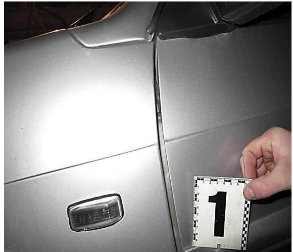
Рисунок 3.103 – Вузловий (а) та детальний (б) вигляди збільшення зазору між задньою частиною лівого крила та лівими дверцятами
