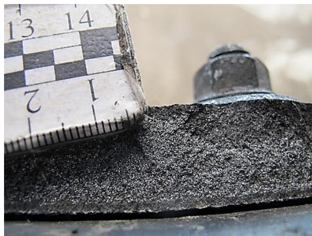
Рисунок В.55 – Детальний вигляд поверхні зламу зруйнованого кронштейна кріплення повздовжнього важеля підвіски лівого заднього подвійного колеса автомобіля MAN TGM
