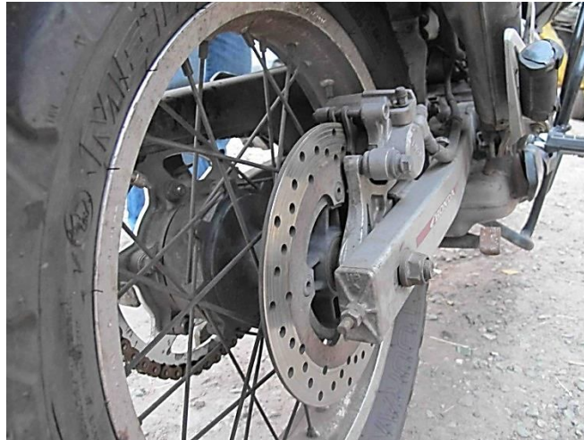
Рисунок 3.23 – Детальний вигляд ззаду справа відсутності підтікань гальмівної рідини в районі одноциліндрового супорту гальмівного механізму заднього колеса
