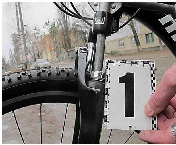
Рисунок 3.74 – Загальний (а) та вузловий (б) вигляди руйнування передньої вилки в верхній частині
