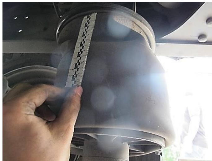
Рисунок В.51 – Детальний вигляд пневмопружини підвіски лівого заднього подвійного колеса автомобіля MAN TGM
