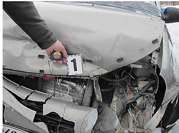
Рисунок 3.137 – Детальні вигляди пошкоджень та нашарувань речовини білого кольору в правій (а) та лівій частинах (б) деформацій в передній частині капота
