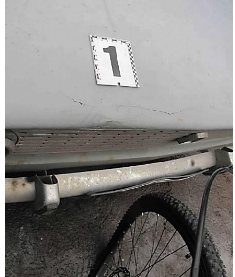
Рисунок 3.63 – Загальний (а) та вузловий (б) вигляди пошкодження у вигляді деформації правої передньої частини капота
