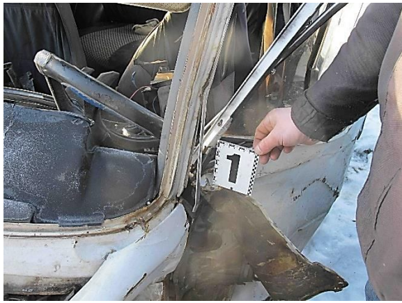
Рисунок 3.132 – Вузловий (а) та детальний (б) вигляди кріплення зірваного лівого дзеркала заднього огляду
