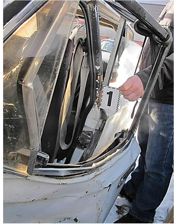
Рисунок 3.125 – Вузловий (а) та детальний (б) вигляди вигину назовні лівої середньої стійки на рівні верхньої частини зовнішньої панелі лівих передніх дверцят
