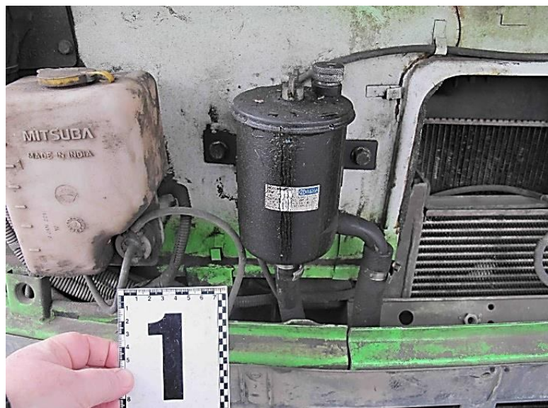
Рисунок Г.15 – Вузловий вигляд відсутності підтікань масла з бачка гідروпідсилювача керма
