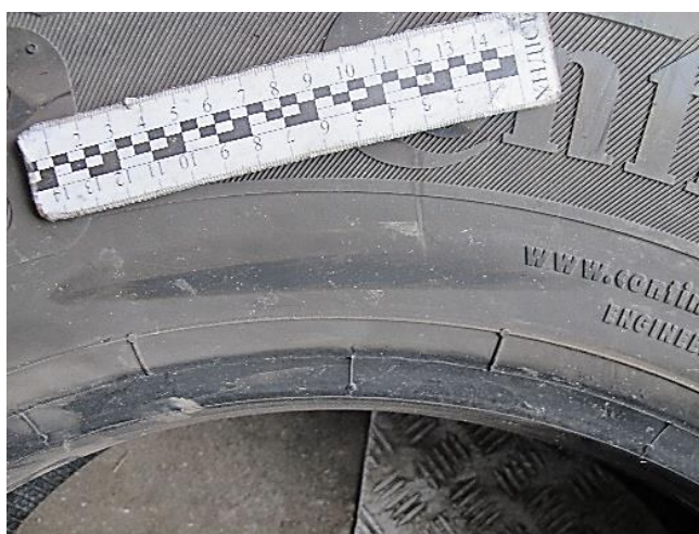
Рисунок В.67 – Детальний вигляд пошкоджень у вигляді потертостей поверхневого герметизуючого шару гуми на зовнішньому боці шини зовнішнього колеса лівого заднього подвійного колеса автомобіля MAN TGM
