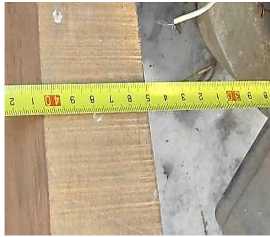
Рисунок 3.118 – Вузловий (а) та детальний (б) вигляди замірів зміщення лівого переднього кута кузова автомобіля ВАЗ-2102
