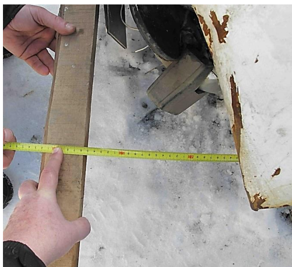
Рисунок 3.117 – Вузловий (а) та детальний (б) вигляди замірів зміщення панелі рамки радіатора в лівій частині автомобіля ВАЗ-2102
