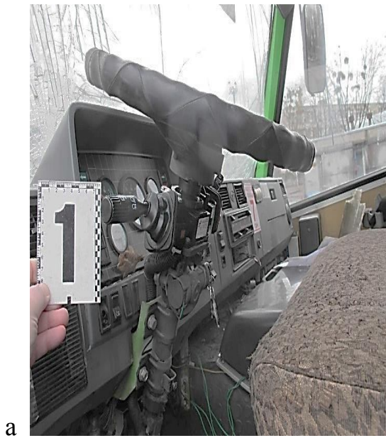
Рисунок Г.16 – Вузлові вигляди керма (а) та надійного кріплення рульової колонки (б)
