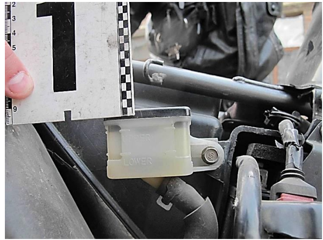
Рисунок 3.21 – Вузловий (а) та детальний (б) вигляди живильного бачка, закріпленого на кронштейні з правого боку рами мотоцикла
