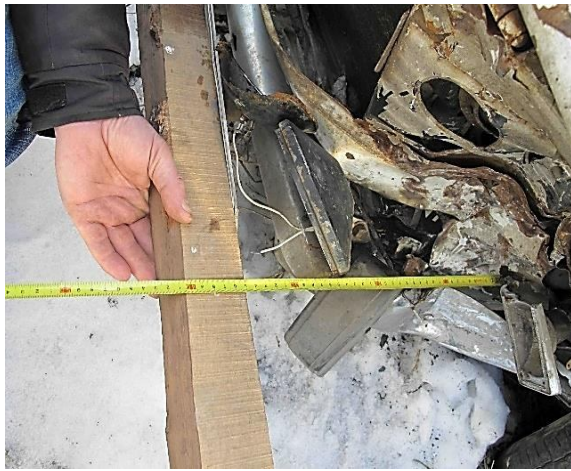
Рисунок 3.118 – Вузловий (а) та детальний (б) вигляди замірів зміщення лівого переднього кута кузова автомобіля ВАЗ-2102
