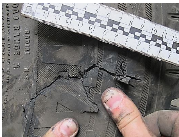
Рисунок В.70 – Детальний вигляд суміщення країв наскрізного пошкодження «В» на зовнішньому боці шини зовнішнього колеса лівого заднього подвійного колеса автомобіля MAN TGM
