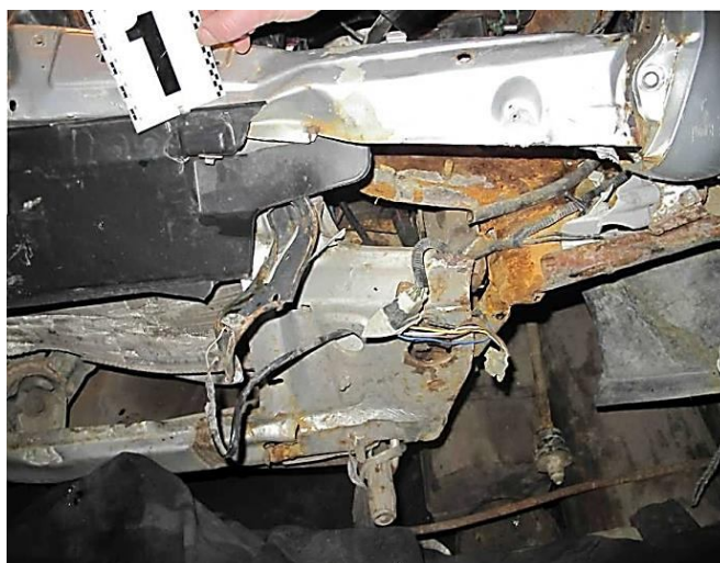
Рисунок 3.99 – Детальний вигляд пошкодження верхньої поперечини рамки радіатора автомобіля ВАЗ-21134 на рівні лівої межі проїому
