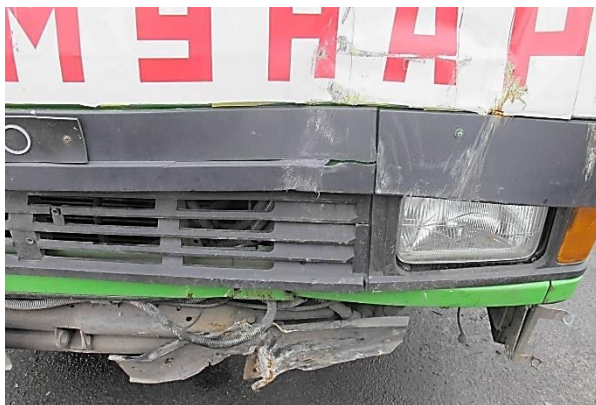
Рисунок Г.6 – Детальні вигляди середньої (а) та нижньої (б) частин пошкоджень у лівій передній частині кузова автобуса
