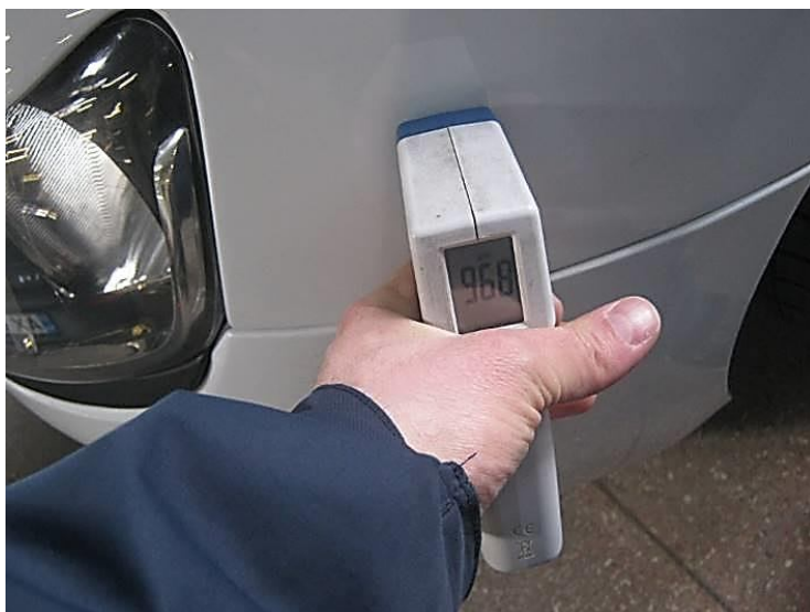
Рисунок Ж.20 – Сліди відновлювального ремонту крила переднього лівого
