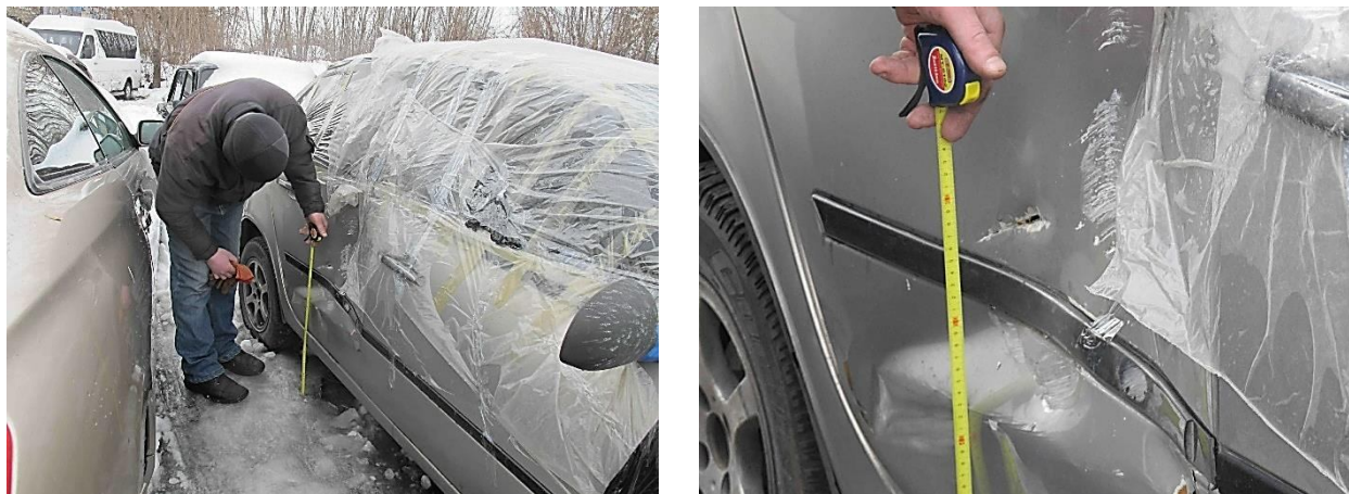
Рисунок 3.143 – Загальний (а) та детальний (б) вигляди пошкоджень на зовнішній панелі правих задніх дверцят
