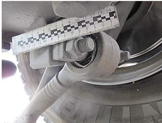
Рисунок В.53 – Детальний вигляд кріплення зруйнованого повздовжнього важеля підвіски лівого заднього подвійного колеса автомобіля MAN TGM
