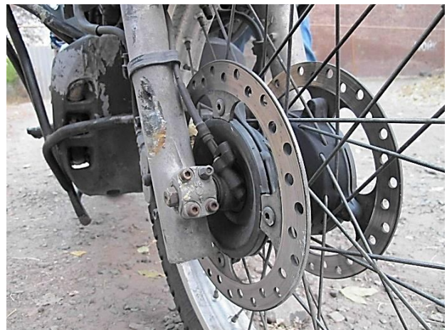
Рисунок 3.19 – Вузлові вигляди спереду справа (а) та спереду зліва (б) дійсного стану гальмівних дисків гальмівного механізму переднього колеса
