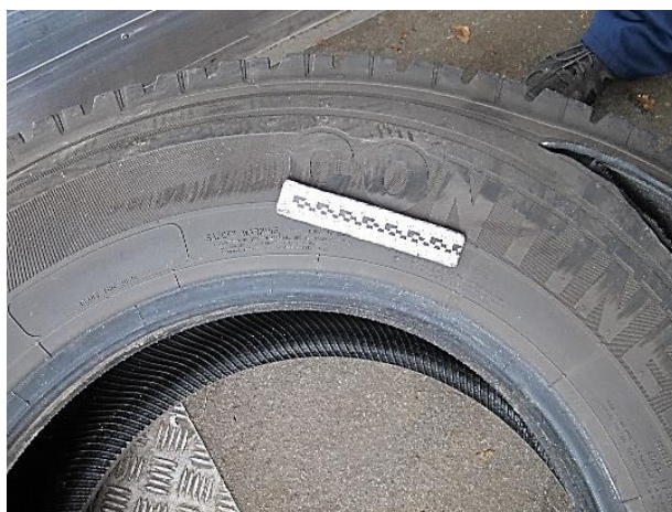
Рисунок В.68 – Детальний вигляд пошкоджень у вигляді потертостей поверхневого герметизуючого шару гуми на внутрішньому боці шини зовнішнього колеса лівого заднього подвійного колеса автомобіля
