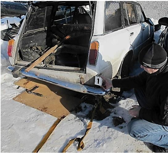
Рисунок 3.130 – Вузловий (а) та детальний (б) вигляди деформації лівого кута заднього бампера
