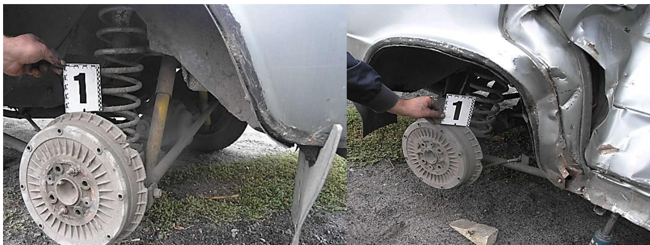
Рисунок 3.40 – Загальний та детальний вигляди збоку барабана гальмівного механізму правого заднього колеса
