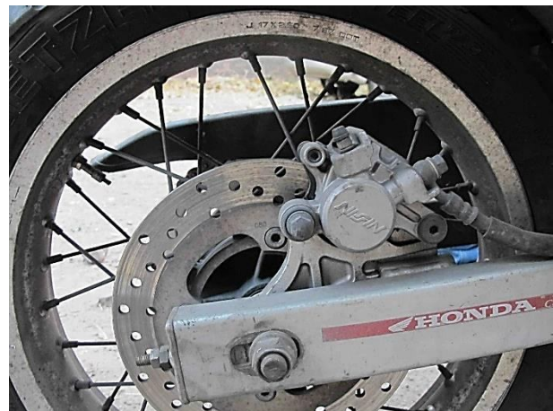
Рисунок 3.22 – Вузлові вигляди збоку відсутності підтікань гальмівної рідини в районі одноциліндрового супорту гальмівного механізму заднього колеса
