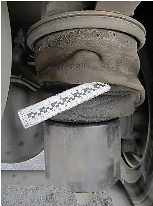
Рисунок В.46 – Детальний вигляд пневмопружины підвіски правого заднього подвійного колеса автомобіля MAN TGM
