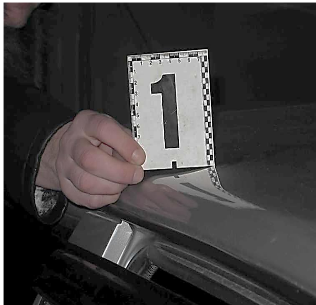
Рисунок 3.106 – Загальний (а) та детальний (б) вигляди деформації даху на рівні середньої стійки правої боковини
