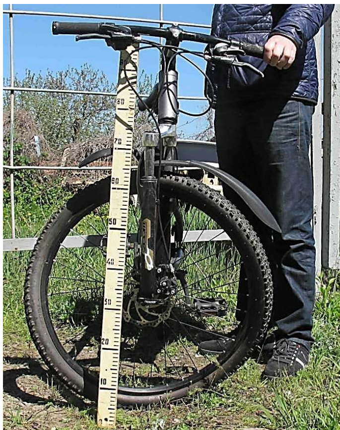
Рисунок 3.7 – Загальний та вузловий вигляди звернутого керма та відсутності пошкоджень манеток та тросів керування
