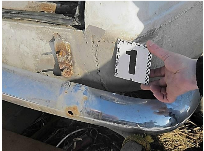
Рисунок 3.130 – Вузловий (а) та детальний (б) вигляди деформації лівого кута заднього бампера
