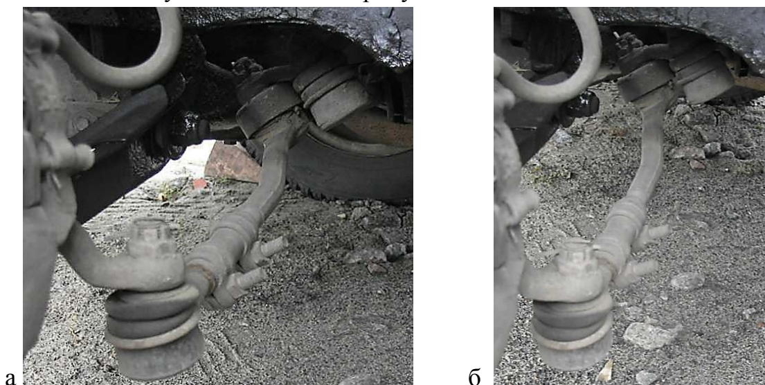
Рисунок 3.46 – Вузловий (а) та детальний (б) вигляди дійсного стану кульового шарніра
