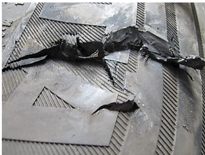
Рисунок В.71 – Детальний вигляд торців наскрізного пошкодження «В» на зовнішньому боці шини зовнішнього колеса лівого заднього подвійного колеса автомобіля MAN TGM
