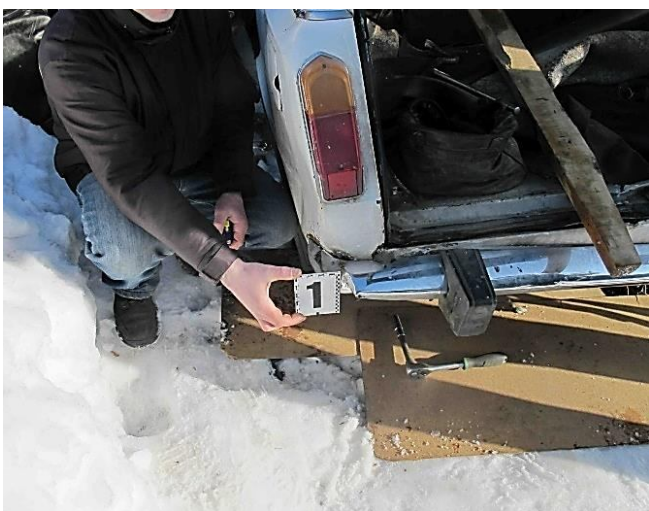
Рисунок 3.129 – Вузловий (а) та детальний (б) вигляди деформації лівого кута заднього бампера
