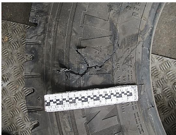
Рисунок В.69 – Детальний вигляд наскрізного пошкодження «В» на зовнішньому боці шини зовнішнього колеса лівого заднього подвійного колеса автомобіля MAN TGM
