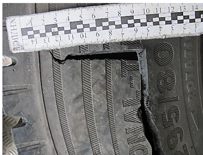
Рисунок В.74 – Детальний вигляд наскрізного пошкодження «Г» на внутрішньому боці шини зовнішнього колеса лівого заднього подвійного колеса автомобіля MAN TGM
