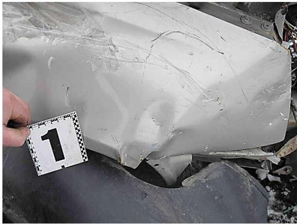
Рисунок 3.152 – Детальні вигляди збоку (а) та спереду зверху (б) пошкоджень на правому передньому крилі
