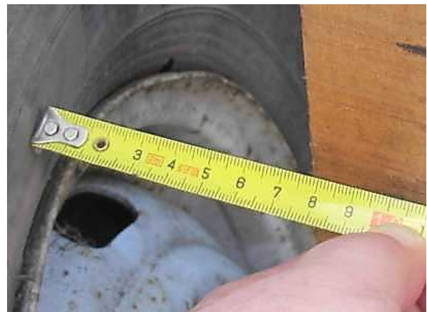
Рисунок 3.153 – Вузловий (а) та детальний (б) вигляди замірів зміщення верхньої частини лівого переднього колеса автомобіля ВАЗ-2102
