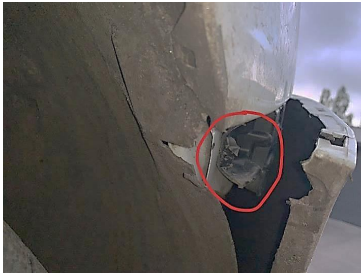
Рисунок Ж.17 – Пошкодження кронштейна правого бампера переднього
