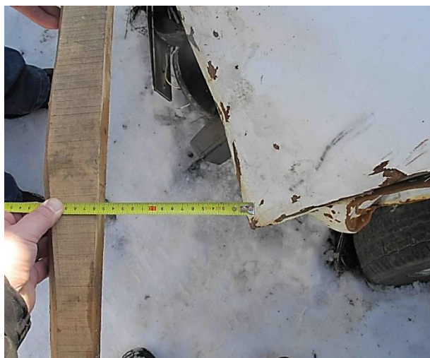
Рисунок 3.116 – Вузловий (а) та детальний (б) вигляди замірів зміщення капота автомобіля ВАЗ-2102
