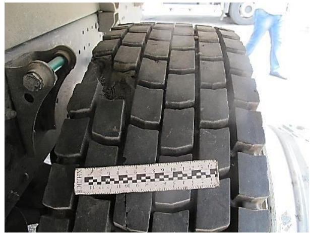
Рисунок В.57 – Детальний вигляд пошкодження протекторної частини внутрішнього колеса лівого заднього подвійного колеса автомобіля MAN TGM у вигляді виривання гуми
