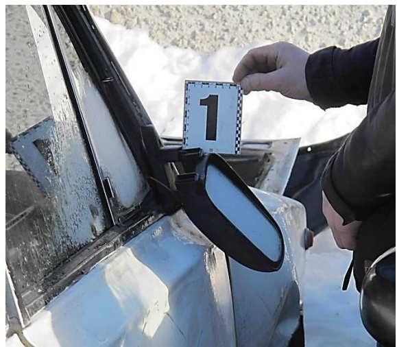
Рисунок 3.131 – Вузловий (а) та детальний (б) вигляди зірваного правого дзеркала заднього огляду
