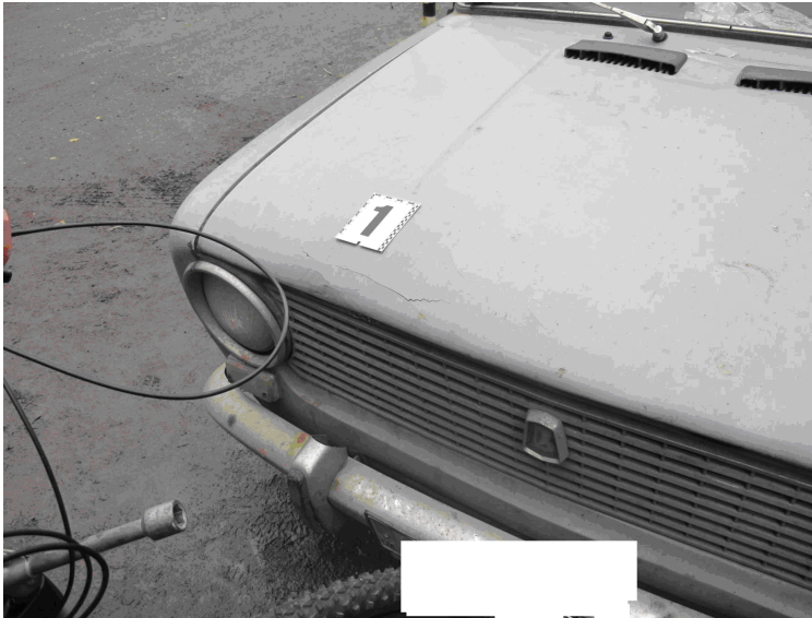
Рисунок 3.63 – Загальний (а) та вузловий (б) вигляди пошкодження у вигляді деформації правої передньої частини капота
