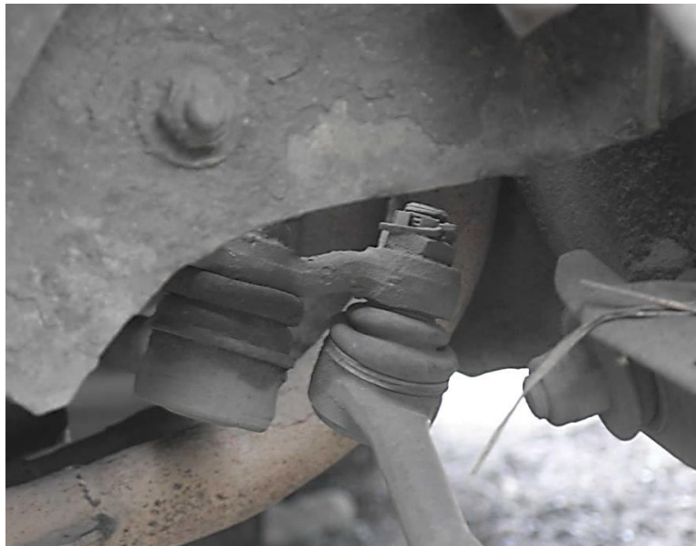
Рисунок 3.47 – Вузловий вигляд дійсного стану кульового шарніра (із захисним чохлам), який надійно сполучений прорізною гайкою шляхом належного шплінтування
