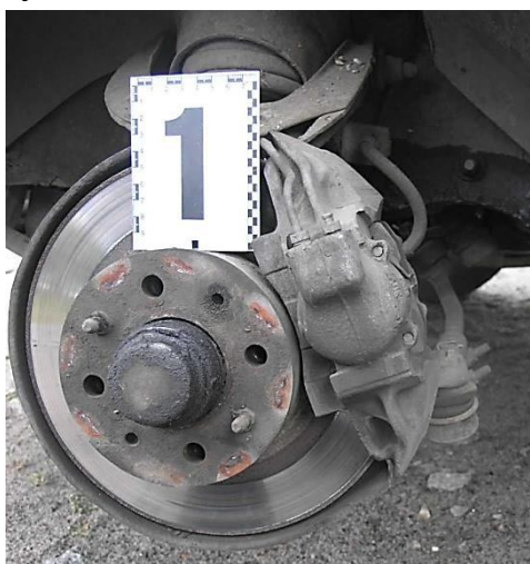
Рисунок 3.37 – Детальні вигляди збоку (а) та спереду (б) дійсного стану гальмівного механізму лівого переднього колеса
