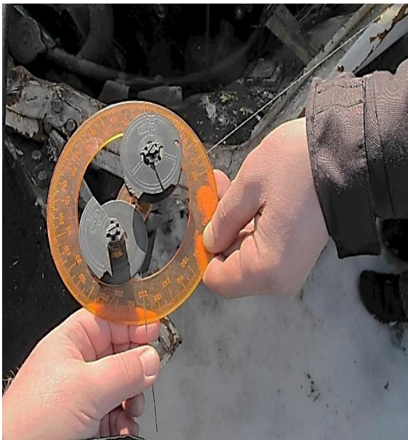
Рисунок 3.147 – Загальні вигляди встановлення величини кута за пошкодженнями на автомобілі ВАЗ-2102 з урахуванням пошкоджень на автомобілі ВАЗ-11183 (з урахуванням взаємно контактуючих пар на них)
