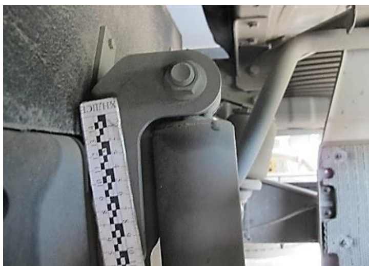
Рисунок В.30 – Детальний вигляд верхнього кріплення амортизатора лівого переднього колеса автомобіля MAN TGM
