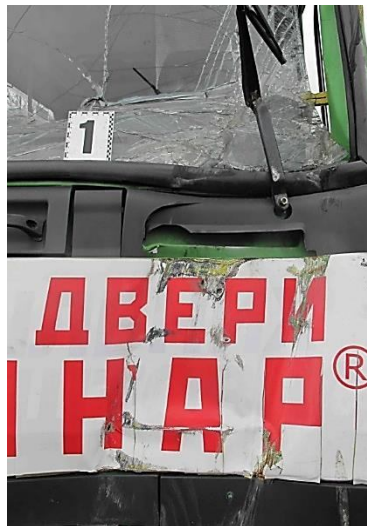
Рисунок Г.5 – Детальний вигляд верхньої частини пошкоджень у лівій передній частині кузова автобуса
