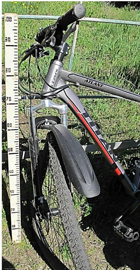
Рисунок 3.6 – Кермо велосипеда звернуто ліворуч, однак троси керування та манетки не пошкоджені
