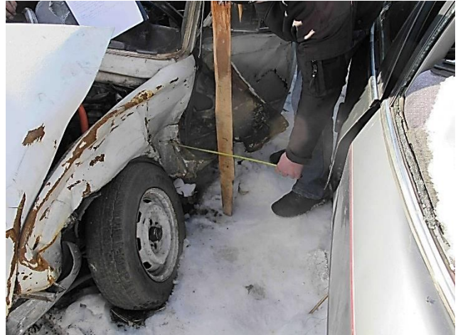
Рисунок 3.120 – Вузлові вигляди замірів глибини увігнутостей в районі лівого переднього крила автомобіля ВАЗ-2102
