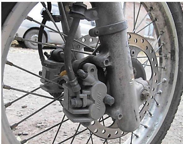
Рисунок 3.19 – Вузлові вигляди спереду справа (а) та спереду зліва (б) дійсного стану гальмівних дисків гальмівного механізму переднього колеса
