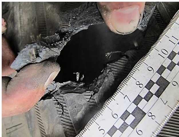
Рисунок В.73 – Детальний вигляд торців наскрізного пошкодження «В» на зовнішньому боці шини зовнішнього колеса лівого заднього подвійного колеса автомобіля MAN TGM
