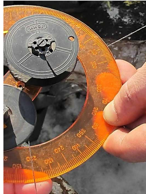
Рисунок 3.147 – Загальні вигляди встановлення величини кута за пошкодженнями на автомобілі ВАЗ-2102 з урахуванням пошкоджень на автомобілі ВАЗ-11183 (з урахуванням взаємно контактуючих пар на них)
