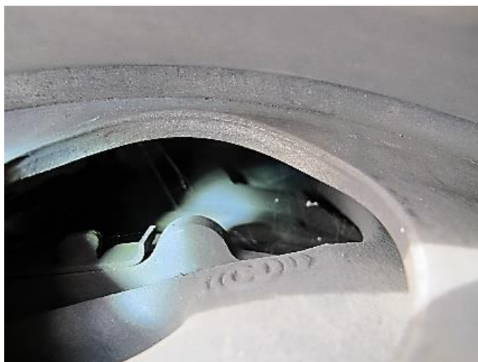
Рисунок В.16 – Детальний вигляд гальмівних накладок супорту лівого переднього колеса автомобіля MAN TGM
