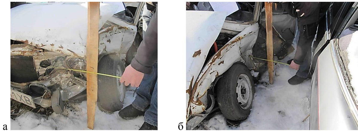
Рисунок 3.154 – Вузловий (а) та детальний (б) вигляди замірів зміщення верхньої частини лівого переднього колеса автомобіля ВАЗ-2102
