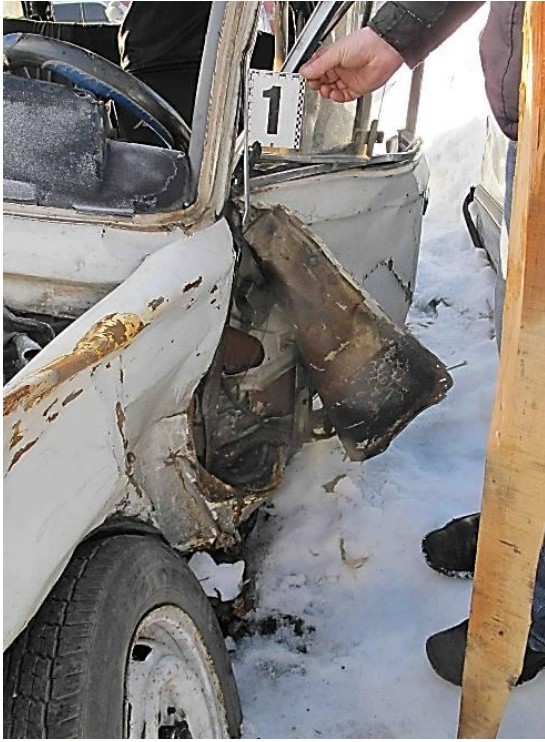
Рисунок 3.122 – Загальний вигляд зриву зовнішньої панелі лівих передніх дверцят
