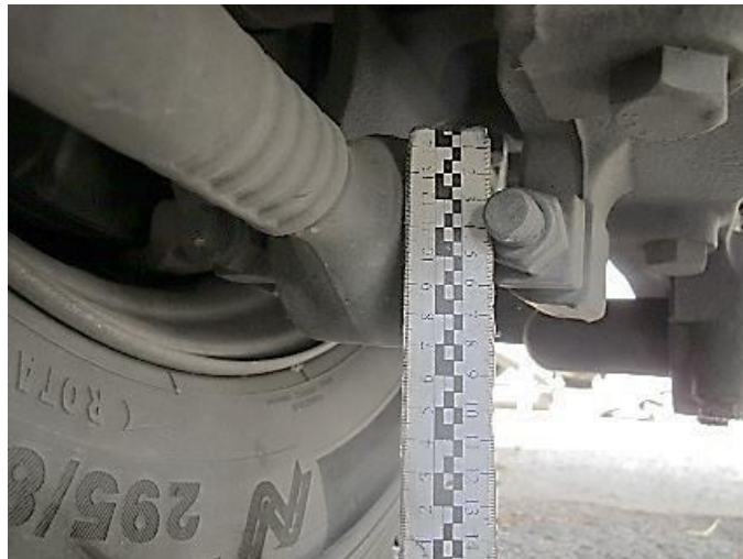
Рисунок В.44 – Детальний вигляд кріплення повздовжнього важеля підвіски правого заднього подвійного колеса автомобіля MAN TGM
