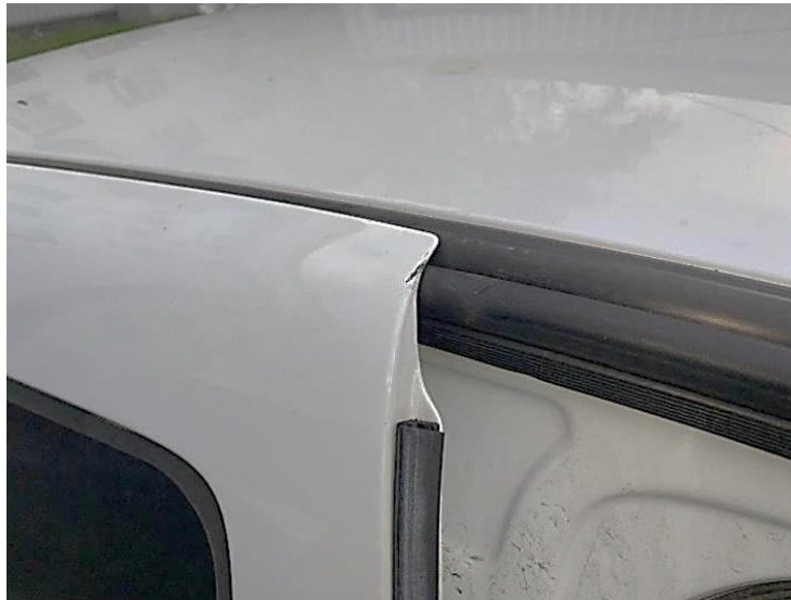
Рисунок Ж.18 – Пошкодження ЛФП двері задньої правої
