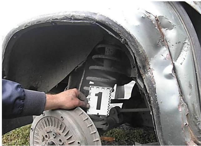
Рисунок 3.51 – Вигляд збоку спереду належного стану пружини задньої підвіски правого колеса
