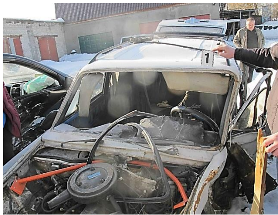
Рисунок 3.155 – Загальний вигляд деформації рамки лобового скла автомобіля ВАЗ-2102
