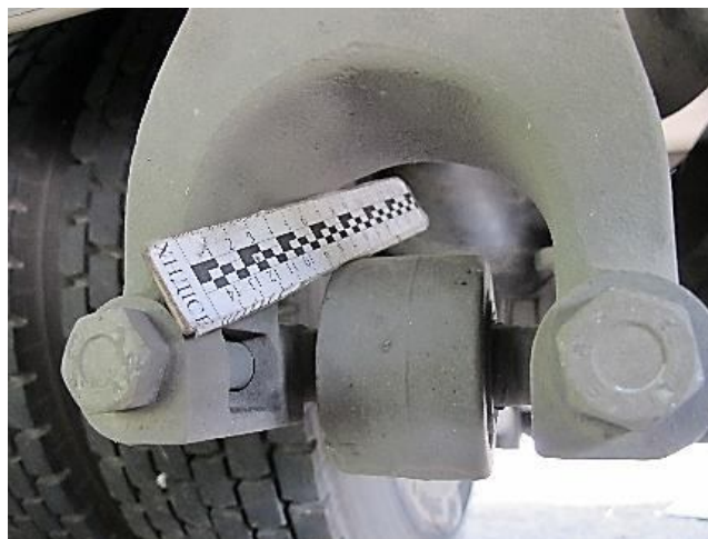
Рисунок В.45 – Детальний вигляд кріплення повздовжнього важеля підвіски правого заднього подвійного колеса автомобіля MAN TGM
