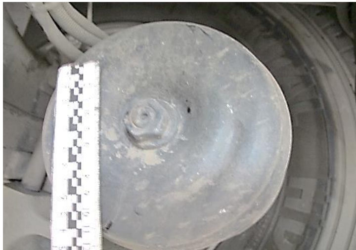
Рисунок В.25 – Детальний вигляд енергоаккумулятора гальмівної пневмокамери правого заднього колеса автомобіля MAN TGM із вкрученим винтом механізму аварійного розгальмування
