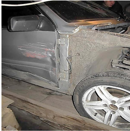
Рисунок 3.107 – Загальний вигляд пошкоджень зовнішньої панелі правих дверцят в передній частині
