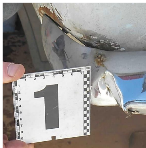
Рисунок 3.129 – Вузловий (а) та детальний (б) вигляди деформації лівого кута заднього бампера
