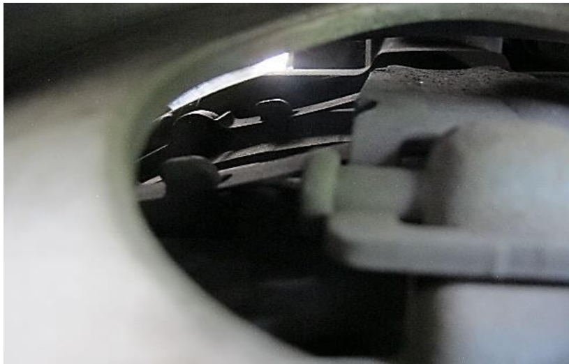
Рисунок В.19 – Детальний вигляд гальмівних накладок супорту правого переднього колеса автомобіля MAN TGM
