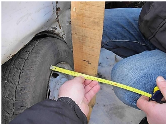
Рисунок 3.153 – Вузловий (а) та детальний (б) вигляди замірів зміщення верхньої частини лівого переднього колеса автомобіля ВАЗ-2102
