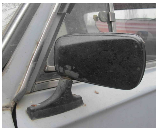
Рисунок 3.71 – Детальні вигляди ззаду (а) та спереду (б) відсутності пошкоджень на лівому дзеркалі заднього огляду
