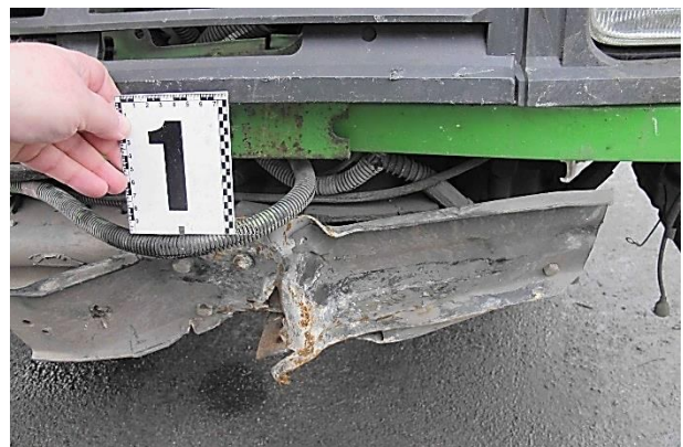
Рисунок Г.6 – Детальні вигляди середньої (а) та нижньої (б) частин пошкоджень у лівій передній частині кузова автобуса
