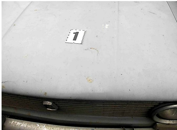
Рисунок 3.64 – Вузловий (а) та детальний (б) вигляди спереду пошкодження у вигляді деформації дугоподібної форми в середній частині капота
