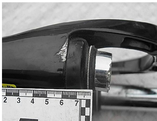
Рисунок 3.79 – Загальний та детальний вигляди розташування пошкодження на лівій верхній частині вилки переднього колеса
