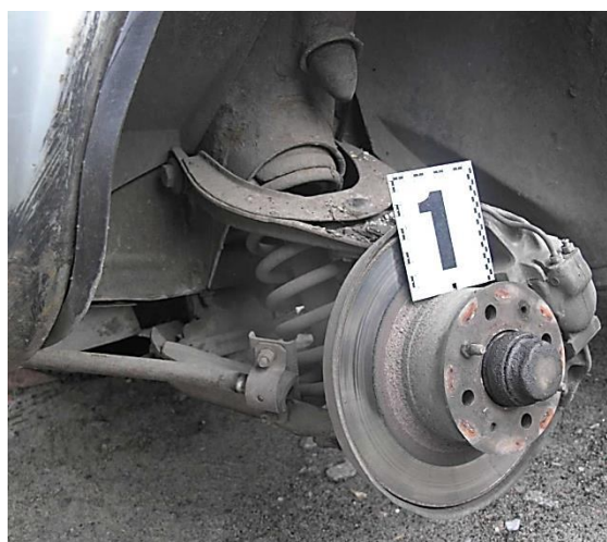
Рисунок 3.37 – Детальні вигляди збоку (а) та спереду (б) дійсного стану гальмівного механізму лівого переднього колеса
