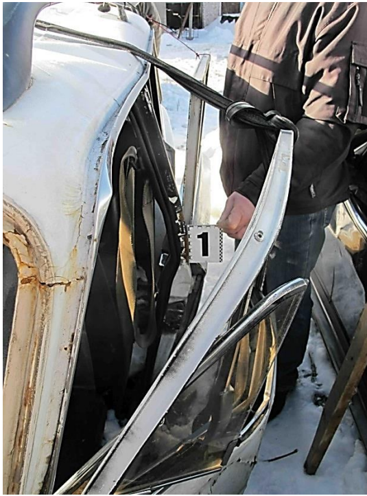
Рисунок 3.125 – Вузловий (а) та детальний (б) вигляди вигину назовні лівої середньої стійки на рівні верхньої частини зовнішньої панелі лівих передніх дверцят
