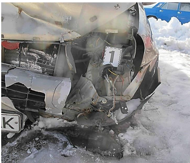
Рисунок 3.138 – Вузлові вигляди зон руйнувань у місцях кріплення блок-фар автомобіля ВАЗ-11183
