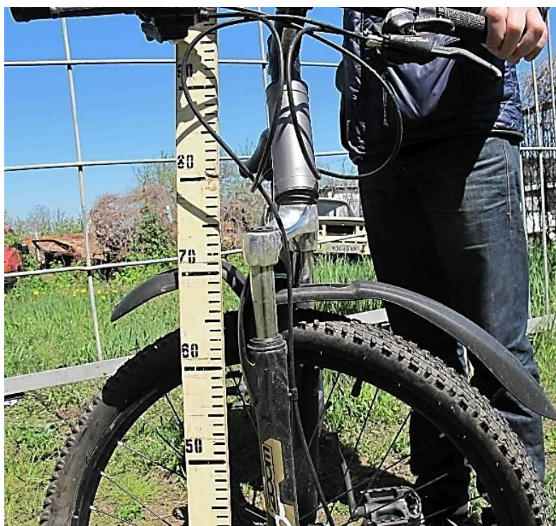
Рисунок 3.8 – На стакані правого пера амортизаційної вилок та правій частині з'єднувального кронштейна наявні подряпини, які розташовуються в передній частині
