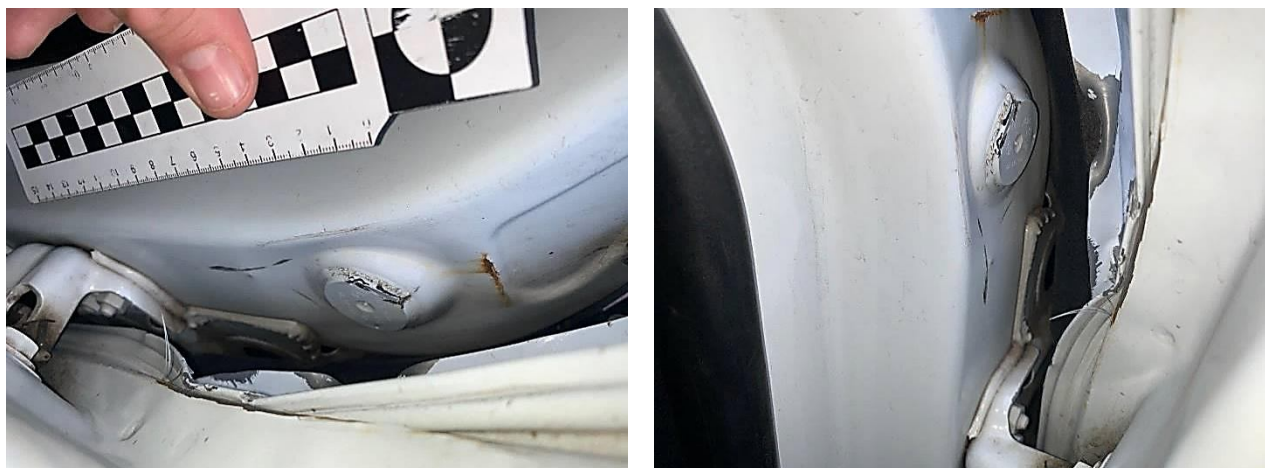
Рисунок Ж.9–Ж.10 – Деформація стійки передньої правої.
