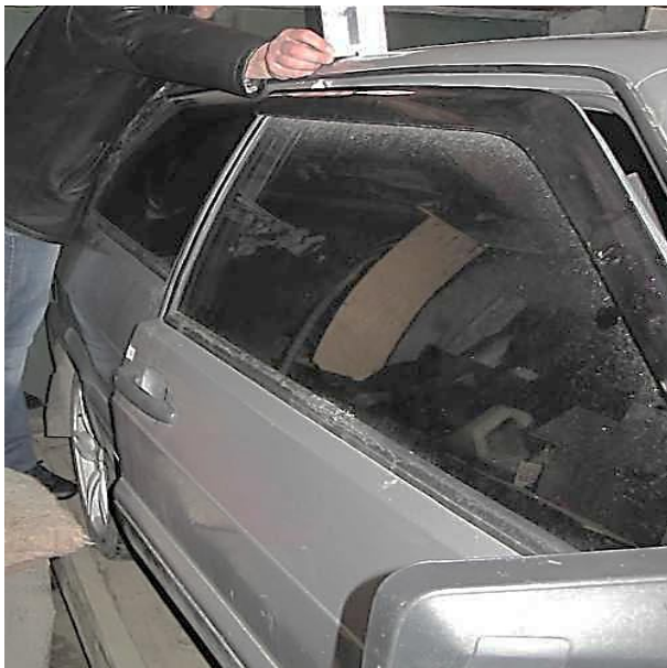
Рисунок 3.106 – Загальний (а) та детальний (б) вигляди деформації даху на рівні середньої стійки правої боковини
