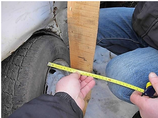
Рисунок 3.119 – Вузловий (а) та детальний (б) вигляди замірів зміщення верхньої частини лівого переднього колеса автомобіля ВАЗ-2102
