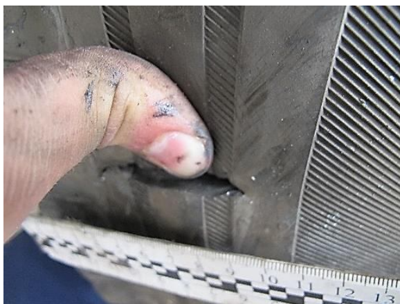
Рисунок В.66 – Детальний вигляд стінок наскрізного пошкодження «Б» на зовнішньому боці шини зовнішнього колеса лівого заднього подвійного колеса автомобіля
