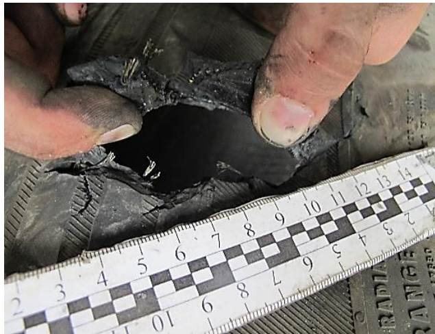
Рисунок В.72 – Детальний вигляд торців наскрізного пошкодження «В» на зовнішньому боці шини зовнішнього колеса лівого заднього подвійного колеса автомобіля MAN TGM
