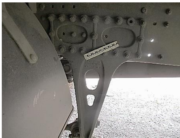
Рисунок В.42 – Детальний вигляд кронштейна кріплення повздовжнього важеля підвіски правого заднього подвійного колеса автомобіля
