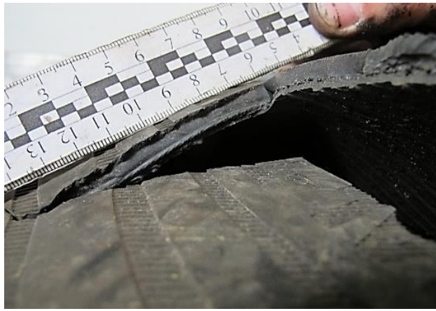
Рисунок В. 75 – Детальний вигляд торців наскрізного пошкодження «Г» на внутрішньому боці шини зовнішнього колеса лівого заднього подвійного колеса автомобіля MAN TGM
