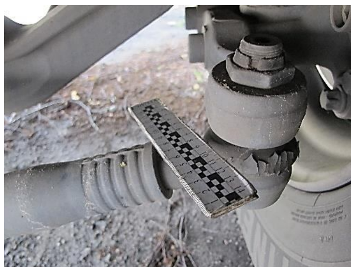
Рисунок В.12 – Детальний вигляд кріплення поперечної рульової тяги до важеля правого поворотного кулака автомобіля MAN TGM
