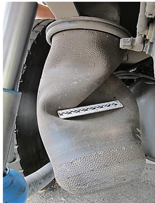
Рисунок В.49 – Детальний вигляд пневмопружины підвіски лівого заднього подвійного колеса автомобіля MAN TGM
