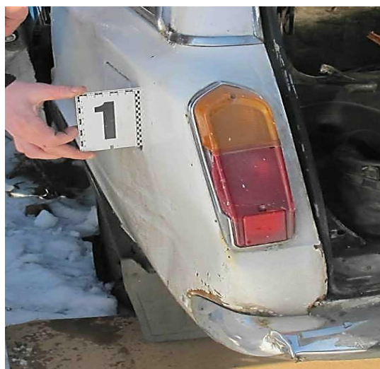
Рисунок 3.128 – Вузловий (а) та детальний (б) вигляди деформації у вигляді увігнутості на лівому задньому крилі
