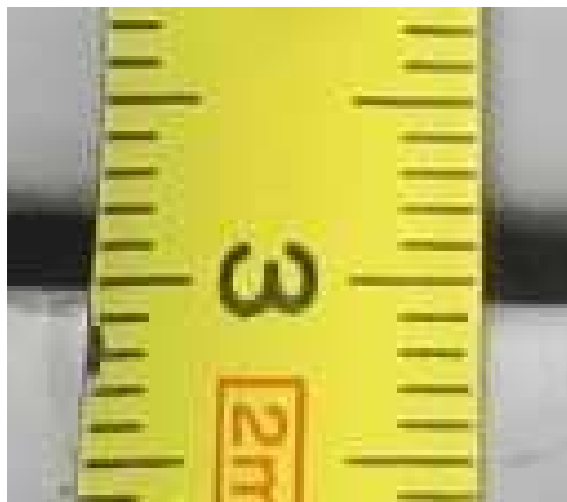
Рисунок 3.68 – Вузловий (а) та детальний (б) вигляди ширини зазору між кромкою капота та верхньою частиною лівого переднього крила (на рівні лівого заднього кута капота)
