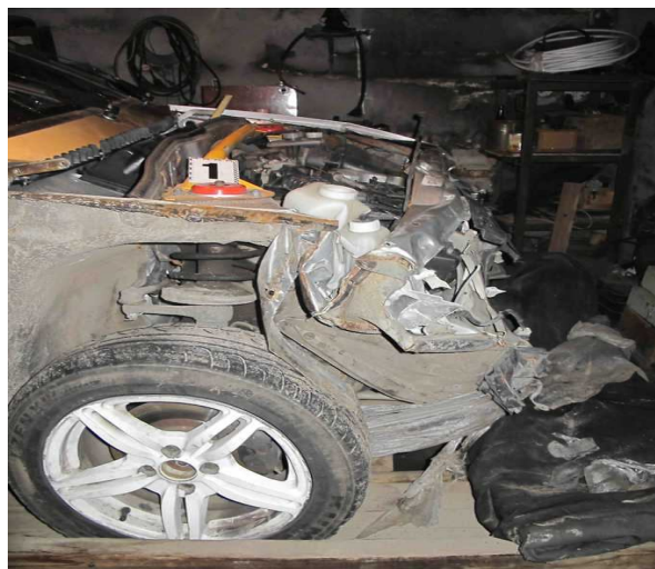
Рисунок 3.96 – Загальний вигляд збоку (а) та детальний вигляд спереду справа (б) пошкоджень у районі правого переднього кута автомобіля ВАЗ-21134
