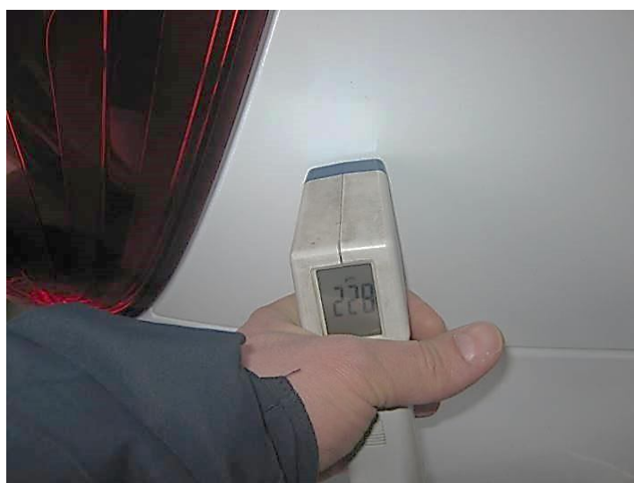
Рисунок Ж.22 – Сліди відновлювального ремонту крила заднього правого
