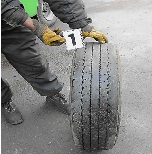
Рисунок Г.19 – Загальний (а) та детальний (б) вигляди дійсного стану рисунок бігової доріжки лівого переднього колеса
