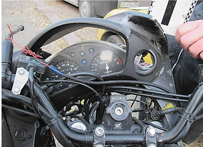
Рисунок 3.24 – Детальний вигляд дійсного стану кріплення керма на верхньому траверсі
