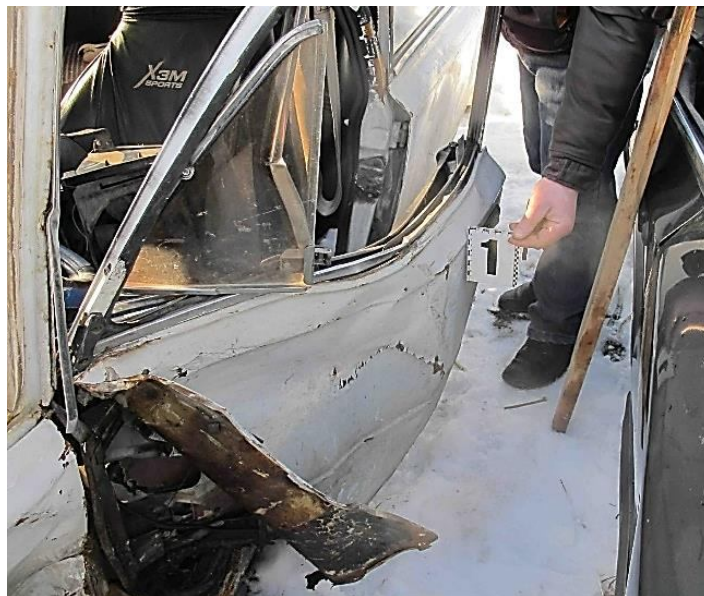
Рисунок 3.151 – Вузловий вигляд вигину назовні в середній частині лівих передніх дверцят
