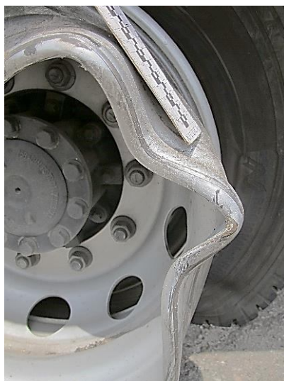
Рисунок В.60 – Детальний вигляд деформацій зовнішньої закраїни ободу зовнішнього колеса лівого заднього подвійного колеса автомобіля MAN TGM у вигляді загину металу в радіальному напрямку до центра колеса
