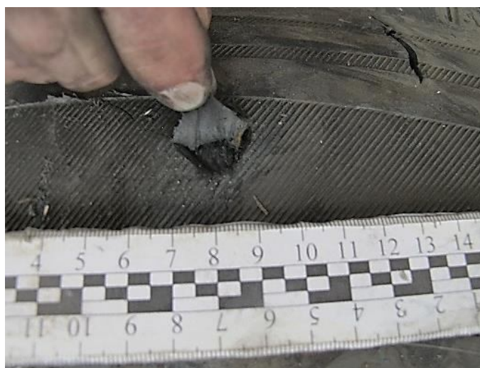
Рисунок В.64 – Детальний вигляд не наскрізного пошкодження «А» на зовнішньому боці шини зовнішнього колеса лівого заднього подвійного колеса автомобіля MAN TGM
