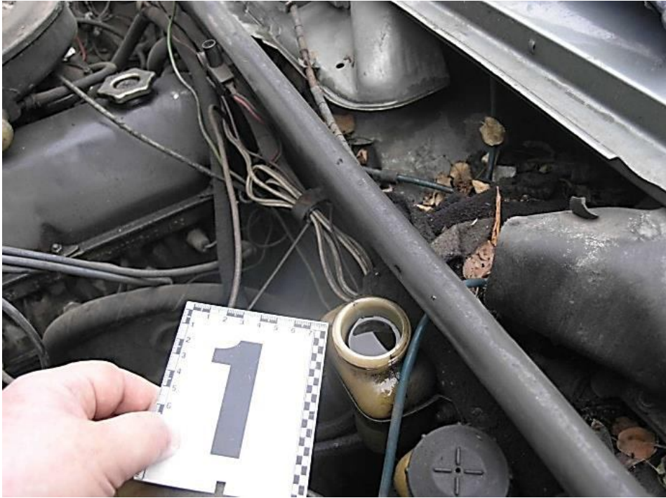
Рисунок 3.35 – Вузловий вигляд наявності гальмівної рідини в бачку головного циліндра
