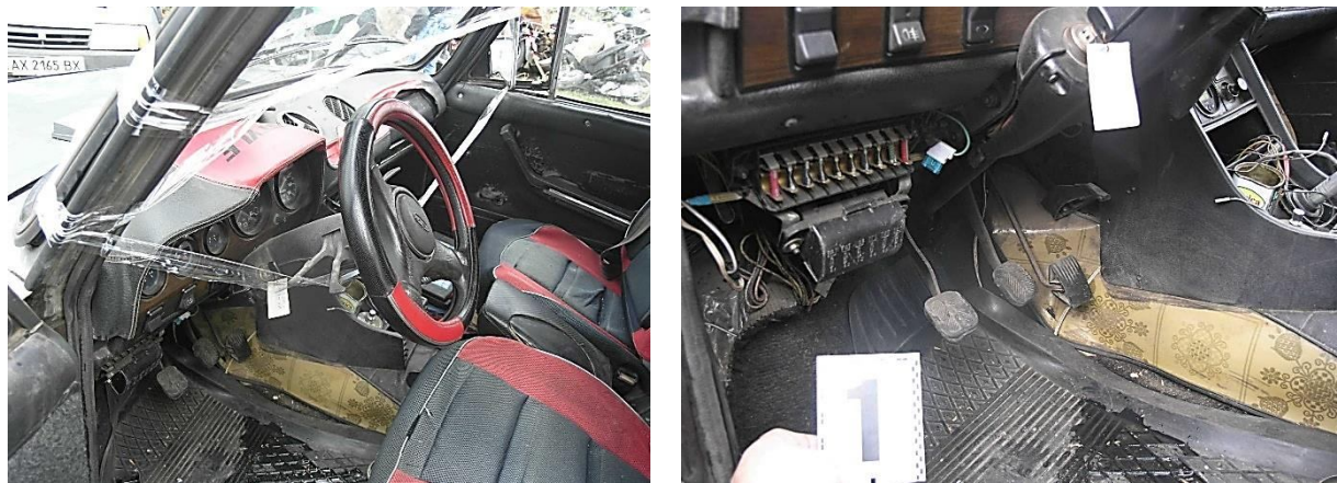
Рисунок 3.34 – Загальний (а) та вузловий (б) вигляди зліва розташування гальмівної педалі. Сліди підтікання гальмівної рідини відсутні
