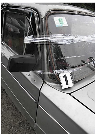
Рисунок 3.31 – Вузловий та детальний вигляди справа пошкодженого кріплення лобового скла автомобіля в районі його правого нижнього кута
