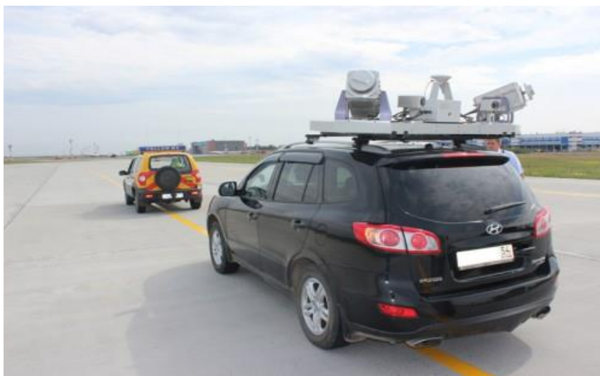
Рисунок 8.5 – Виконання зйомки мобільним лазерним сканувальним пристроєм
