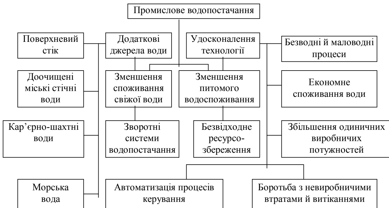
Рисунок 1.1 – Структура водозберігальних заходів
