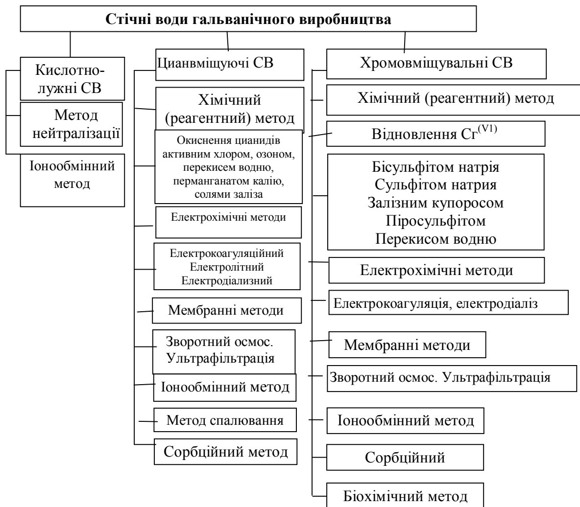
Рисунок 6.1 – Методи очищення стічних вод гальванічних виробництв
