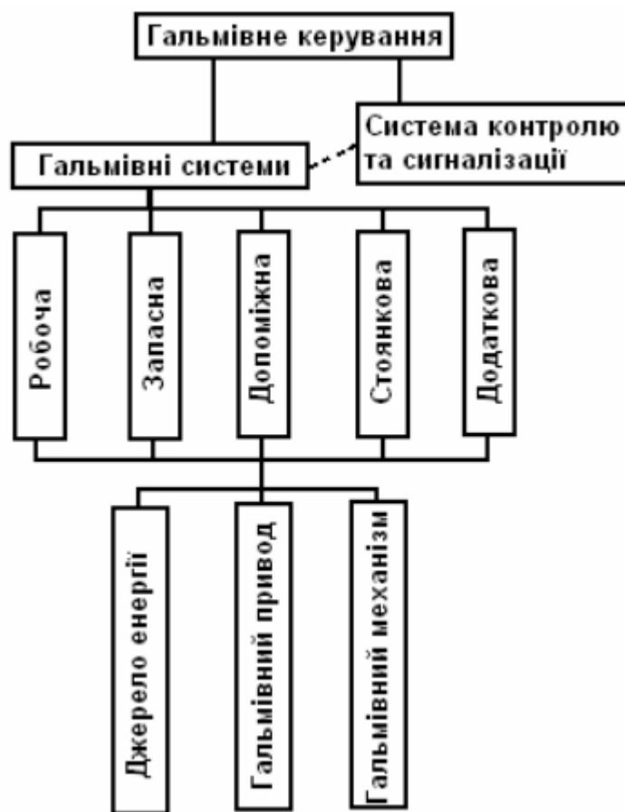
Рисунок 5.1 – Класифікаційна схема гальмівного керування [14]
