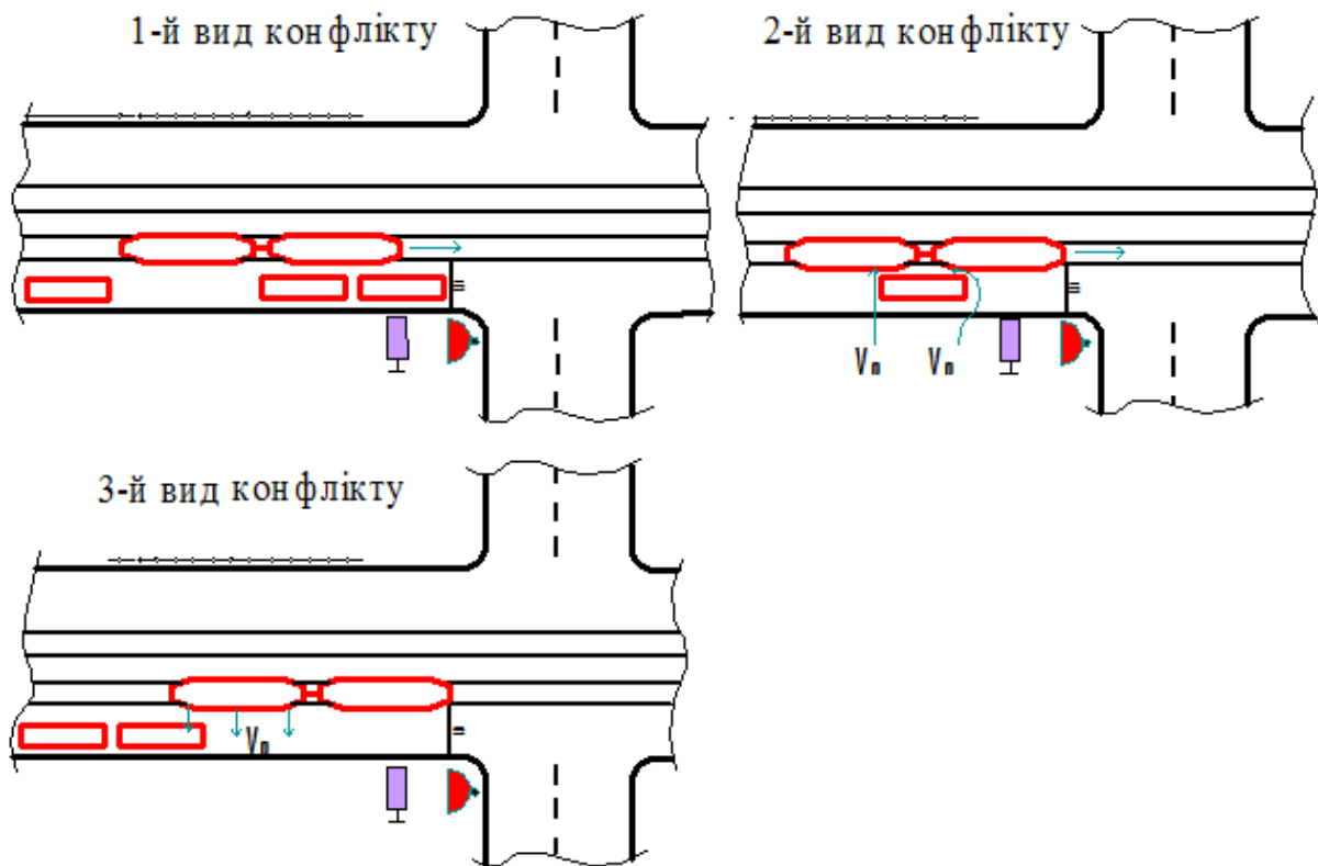
Рисунок 4.4 – Схеми транспортних конфліктів на зупиночних пунктах трамвая у разі розташування трамвайного шляху на одному рівні з проїзною частиною
