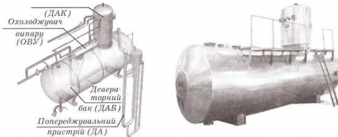
Рисунок 5.2 – Зовнішній вигляд деаeratorів марки ДА-5/2 і ДА 100/ теплоізоляцією та площадками для обслуговування
