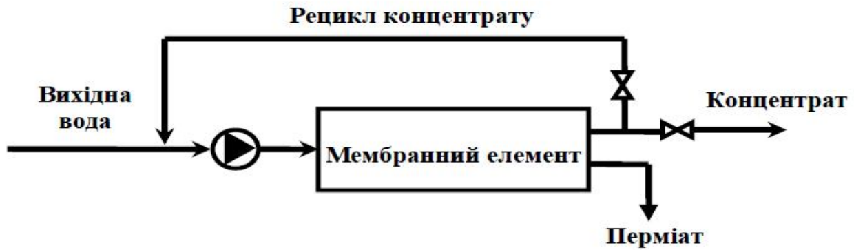
Рисунок 8.12 – Принципова схема системи зворотного осмосу й нанофільтрації з рециклом концентрату
