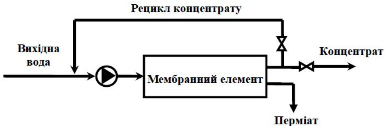
Рисунок 10.14 – Принципова схема системи зворотного осмосу й нанофільтрації з рециклом концентрату
