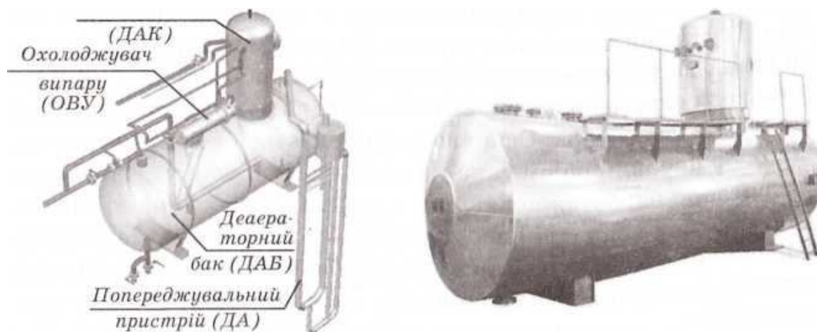
Рисунок 7.2 – Зовнішній вигляд деаераторів марки ДА-5/2 і ДА 100/ теплоізоляцією та площадками для обслуговування
