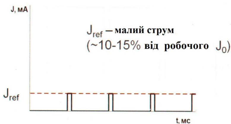
Рисунок 6.13 – Опорні імпульси струму
