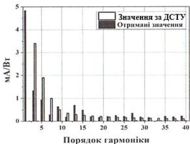
Рисунок 7.18 – Величина струмових гармонік схеми керування з пасивним коректором коефіцієнта потужності та їхнє порівняння з ДСТУ
