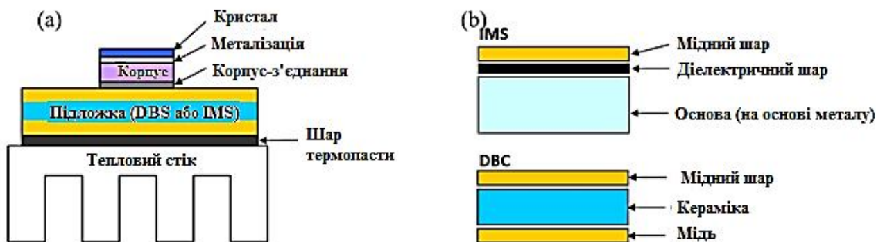
Рисунок 6.7 – а - структура спрощеного СД модуля; б - структура IMS і DBS підложок
