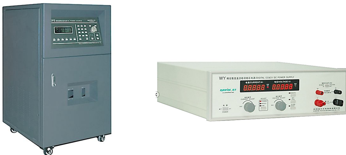
Рисунок 10.14 – Джерела змінного струму (а) та постійного струму (б) для живлення світлодіодних освітлювальних приладів при їх тестуванні
