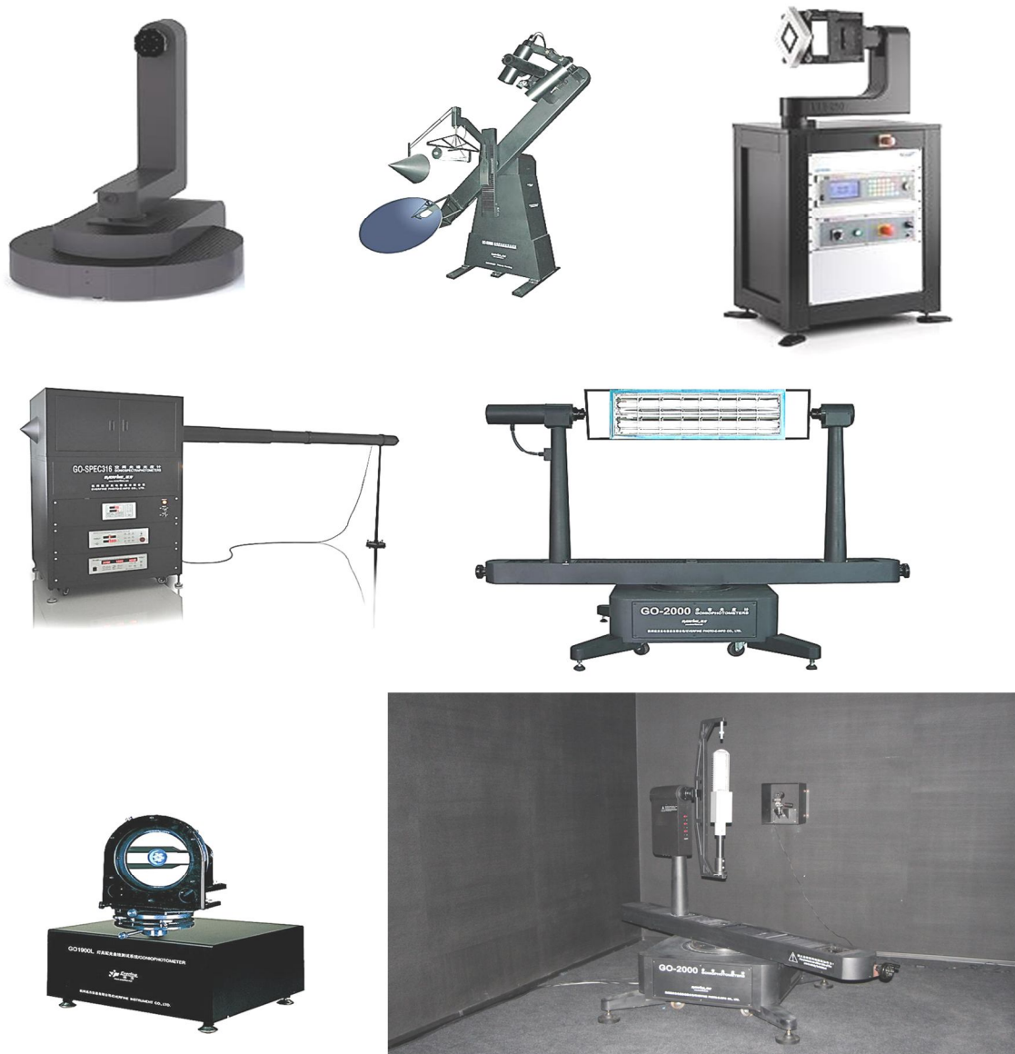
Рисунок 10.13 – Конструкції сучасних гоніофотометрів для вимірювання зразків світлотехнічних приладів із розмірами до 2 \text{ м}^2 \times 2 \text{ м}^2 у геометрії вимірювання СІЕ В- \beta або СІЕ С- \gamma відповідно до міжнародних стандартів
