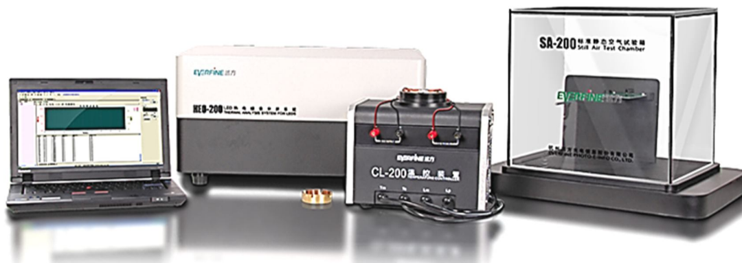
Рисунок 10.2 – Система вимірювання теплових та електричних параметрів світлодіодів
