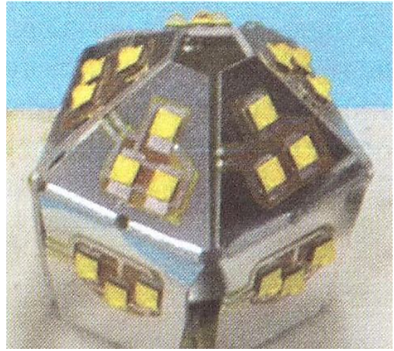
Рисунок 3.17 – Експериментальний зразок об'ємного дзеркалізованого світлодіодного модуля потужністю 10 Вт на SMD-світлодіодах компанії CREE
