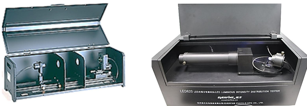
Рисунок 10.1 – Фотографія сучасних гоніофотометрів для світлодіодів
