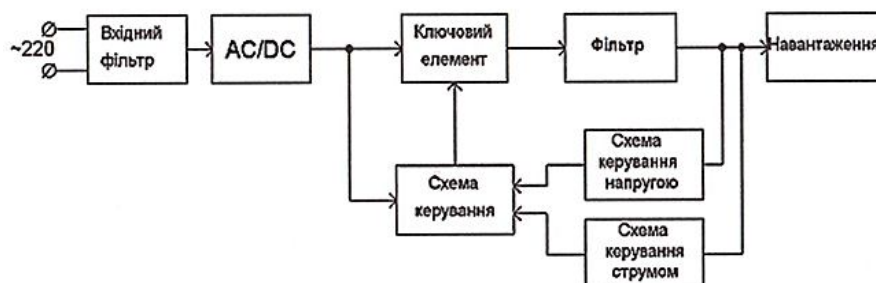
Рисунок 7.15 – Блок-схема гальванічно нерозв'язаної електронної схеми керування
