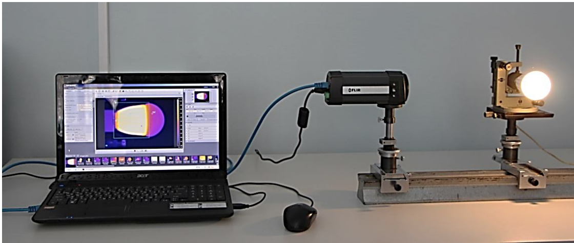
Рисунок 10.17 – Система вимірювання теплових параметрів світлодіодів на основі тепловізора
