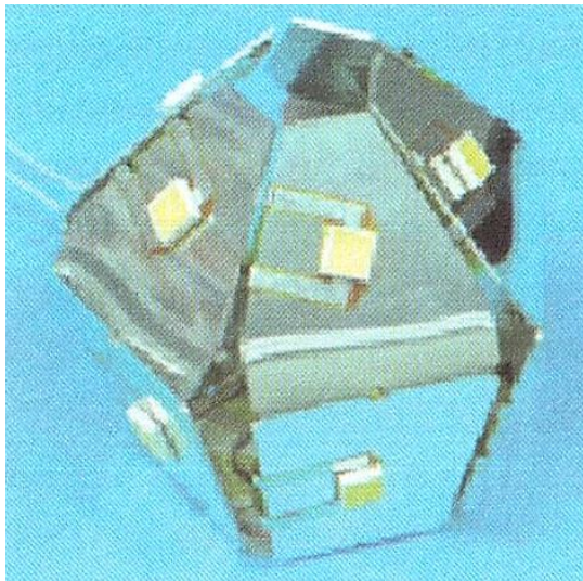
Рисунок 3.18 – Експериментальний зразок об'ємного дзеркалізованого світлодіодного модуля потужністю 15 Вт на міні COB-світлодіодах (10 шт.) компанії CREE
