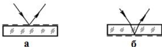
Рисунок 4.1 – Дзеркало з зовнішнім і внутрішнім відбиттям
