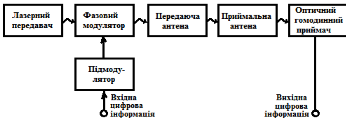
Рисунок 5.15 – Блок-схема лазерної системи зв'язку з кодово-імпульсною модуляцією за фазою й гомодинним приймачем
