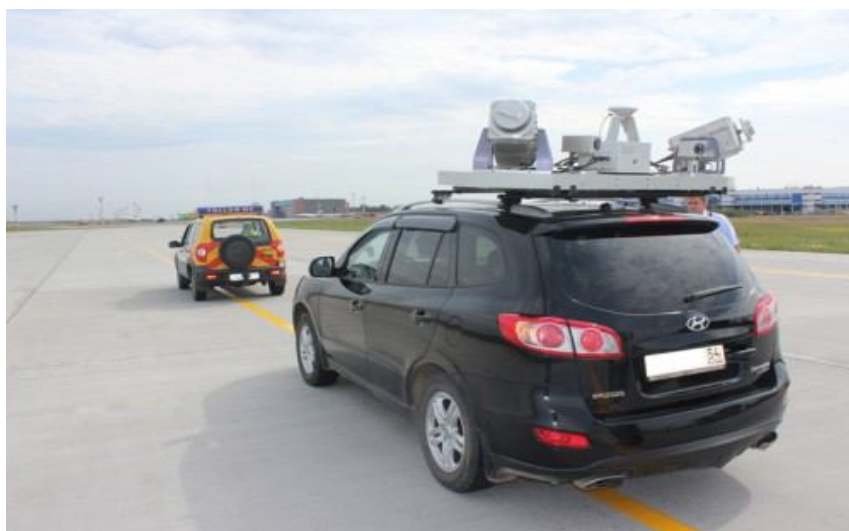
Рисунок 7.8 – Виконання зйомки мобільним лазерним сканувальним пристроєм
