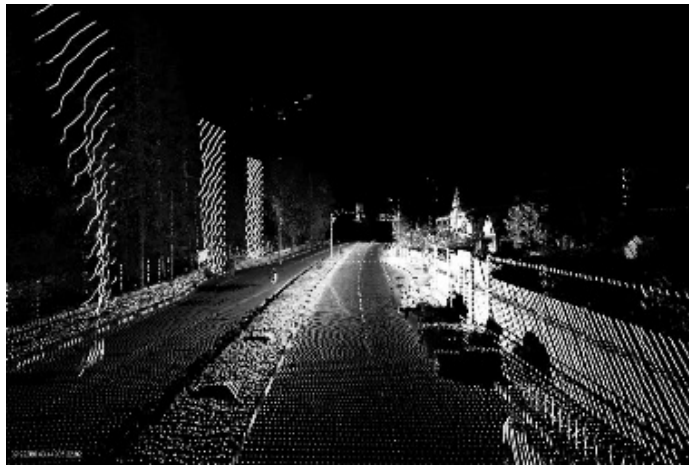
Рисунок 7.5 – Результати сканування у вигляді хмари точок
