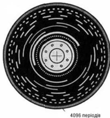
Рисунок 3.1 – Приклад кодованого круга в електронному теодоліті
