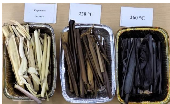
Рис. 3. Загальний вигляд сирові і торефікованої при температурах 220 і 260°C кукурудзи. Зразки лабораторії «DAK-GPS»
