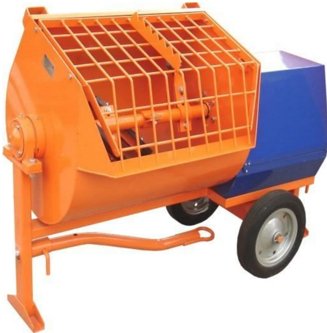
Рисунок 2.9 – Розчинозмішувач з примусовим змішуванням
