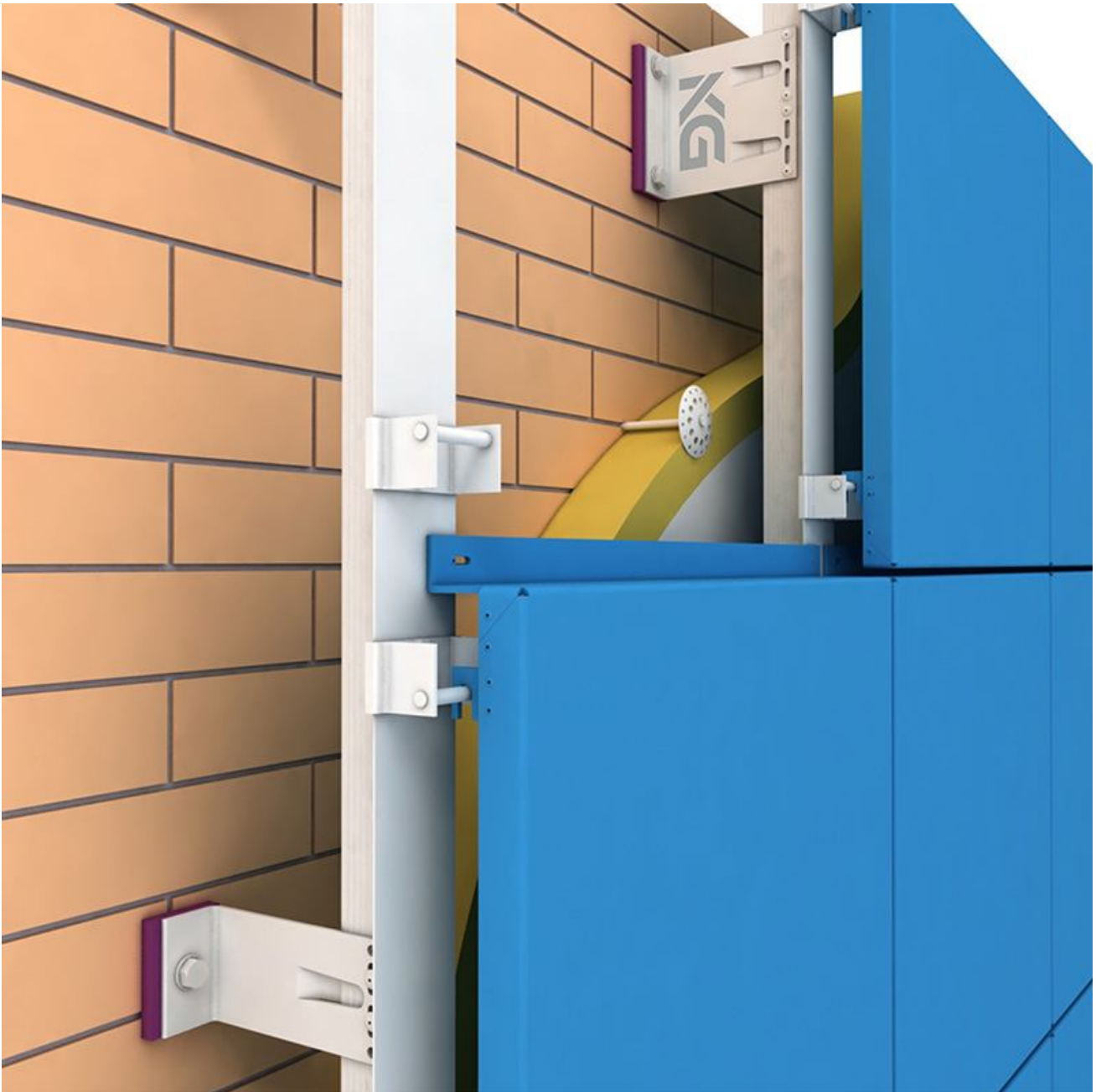
Рисунок 7.47 – Фасадне облицювання з алюмінієвих композитних матеріалів
