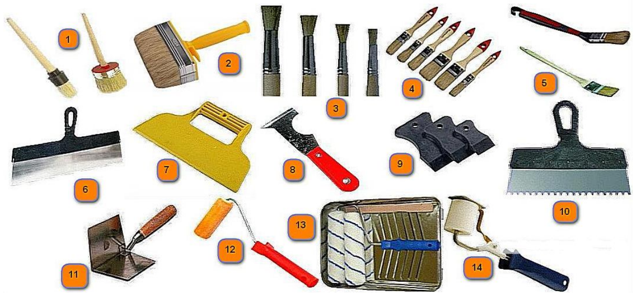
Рисунок 4.1 – Ручний інструмент для малярних робіт: 1 – пензлі-ручники; 2 – макловиця; 3 – фільонковий пензель; 4 – флейцеві пензлі; 5 – радіаторні пензлі; 6 – малярський шпатель; 7 – пластмасовий шпатель; 8 – шпатель-скребок; 9 – гумовий шпатель; 10 – зубчастий шпатель; 11 – кутовий шпатель; 12 – мінівалик; 13 – універсальний валик; 14 – віконний валик
