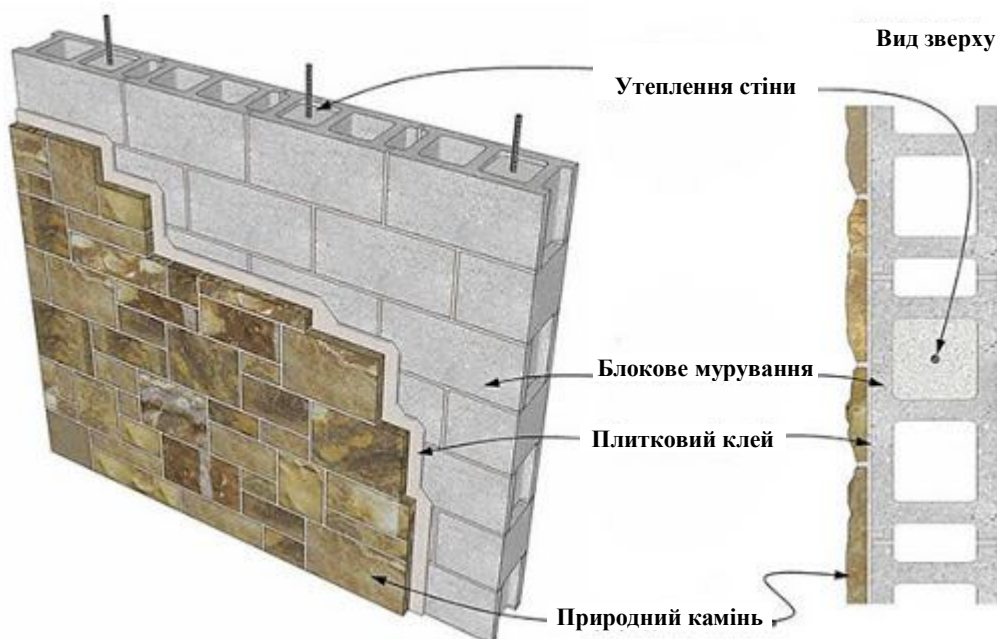
Рисунок 5.14 – Облицювання вертикальних поверхонь плитами з природного каменю
