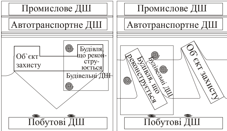
Рис. 3.2. Варіанти взаємного розміщення джерел шуму й об'єктів захисту, що виникають у реальних міських умовах при реконструкції, ремонті й демонтажі будинків і споруд (власні авторські пропозиції відповідно [40]).
