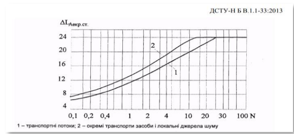
Рис. 8. Визначення ефективності шумозахисного екрану-стілки
