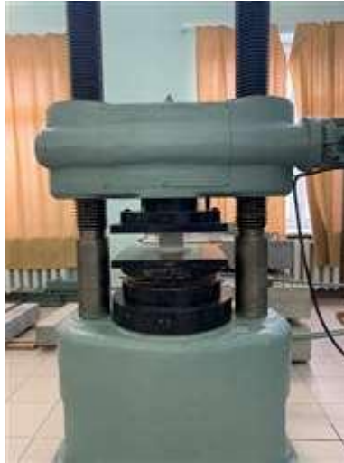
Рисунок 1 - Випробування зразків зі сталевібробетону на стиск
