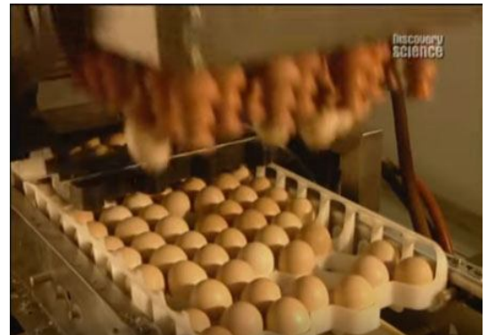
Рис. 6 Фрагмент установки Inovoject (автоматичного вилучення яєць з мертвими ембріонами)
