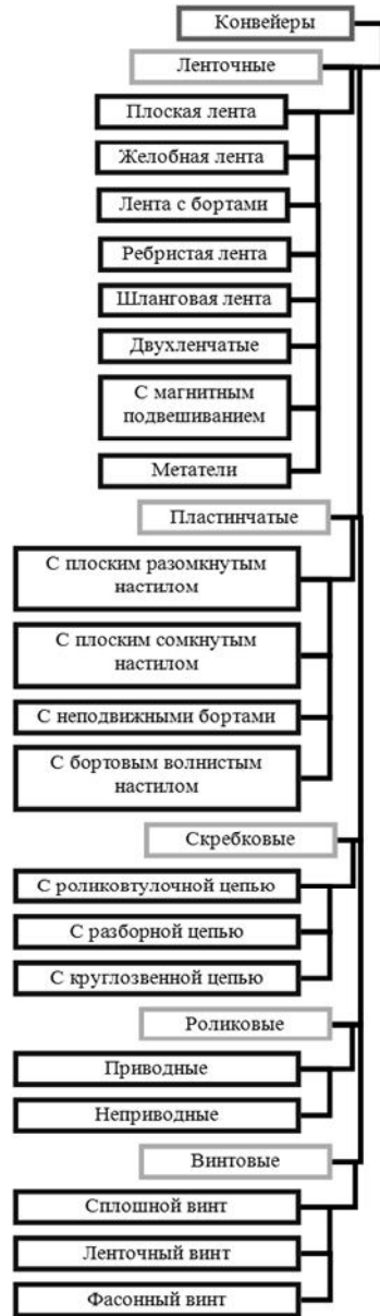
Рис. 7 Фрагмент классификации (первый уровень) конвейеров по основным признакам
