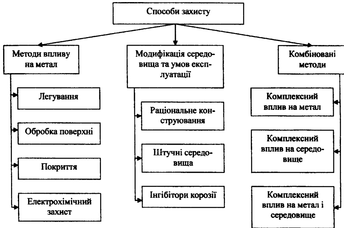
Рисунок 8.1 – Класифікація способів захисту від корозії
