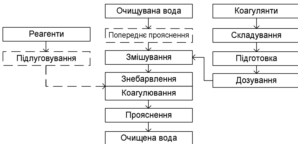
Рисунок 5.5 – Основні технологічні етапи очищення води
