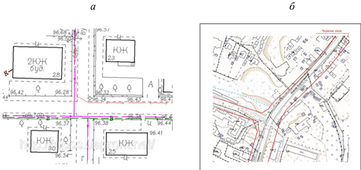
Рисунок 7.4 – Приклад топографічного плану a – М 1:500; б – М 1:2 000
