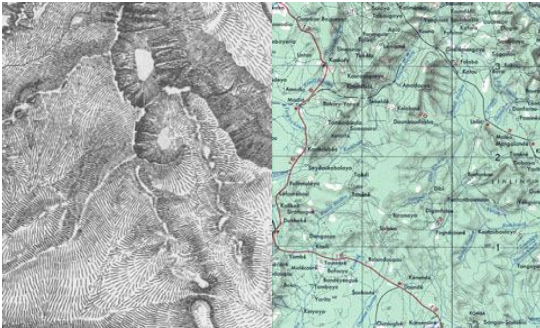
Рисунок 4.12 – Використання методів тіньової пластики дозволяє підкреслити рельєф місцевості:
