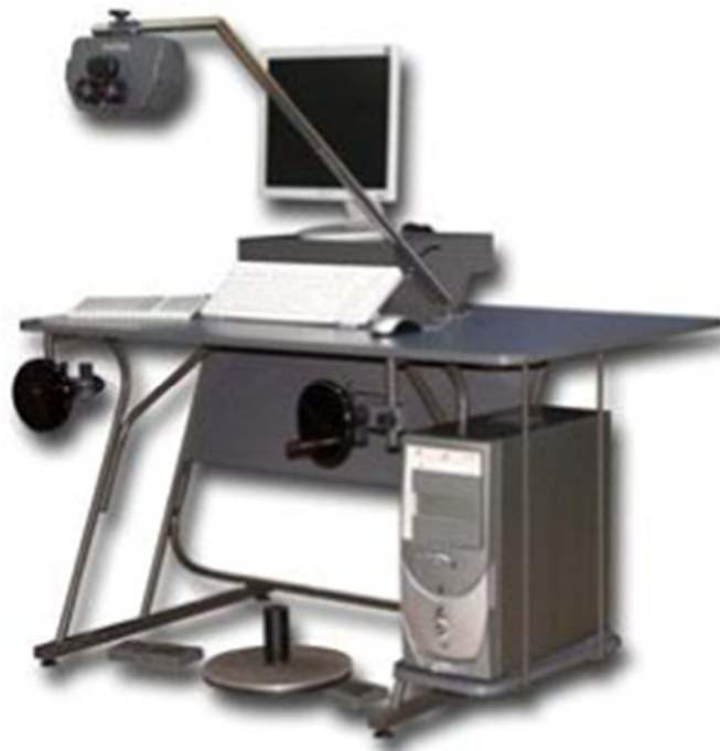
Рисунок 4.1 – Цифрова фотограмметрична станція «Дельта»
