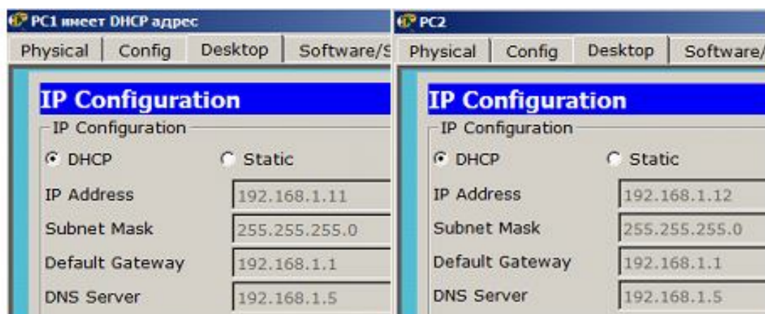
Рисунок 8.3 – PC1 і PC2 отримують IP-адреси від DHCP-сервера
