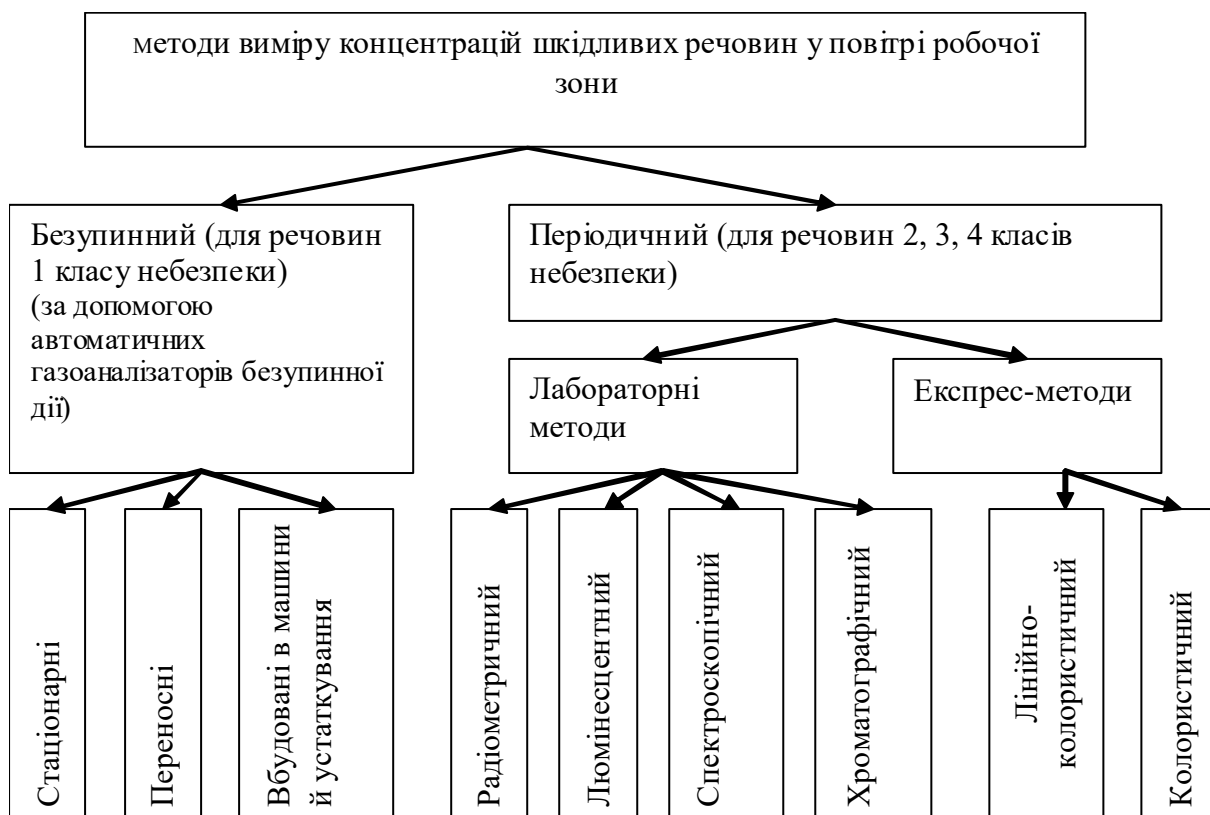
Рисунок 2.1 – Класифікація методів виміру концентрацій шкідливих речовин у повітрі робочої зони
