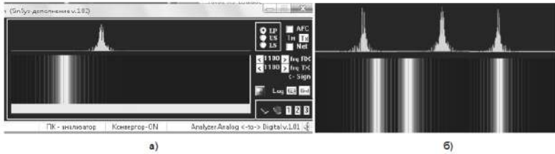
Рисунок 1 – Експериментальний спектроаналіз перетворювача: а – інтерфейс програми контролю інформаційного сигналу; б – інформаційні сигнали від різних джерел
