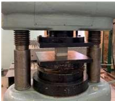
Рисунок 1 - Прес випробувань зразка бетону на міцність при стиску
