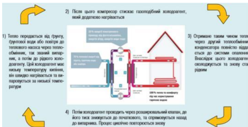
Рисунок 1 – Схема роботи теплового насосу
