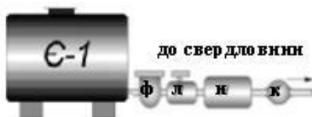
Рисунок 1 – Схема введення ПАР:
