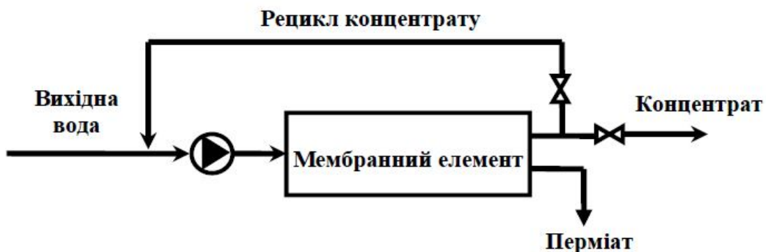
Рисунок 9.14 – Принципова схема системи зворотного осмосу й нанофільтрації з рециклом концентрату
