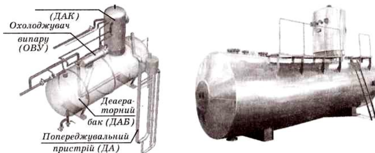
Рисунок 6.2 – Зовнішній вигляд деаераторів марки ДА-5/2 і ДА 100/ теплоізоляцією та площадками для обслуговування
