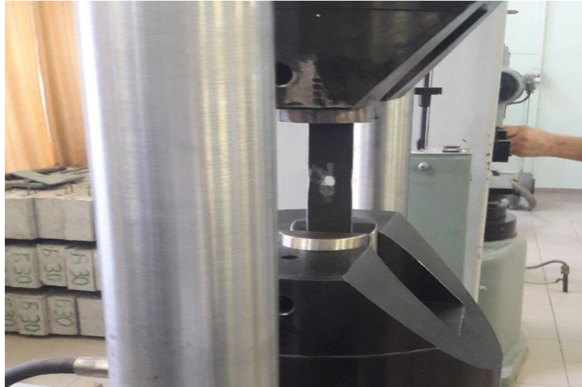
Рисунок 6 – Сталевий зразок з круглим отвором у випробувальній машині
