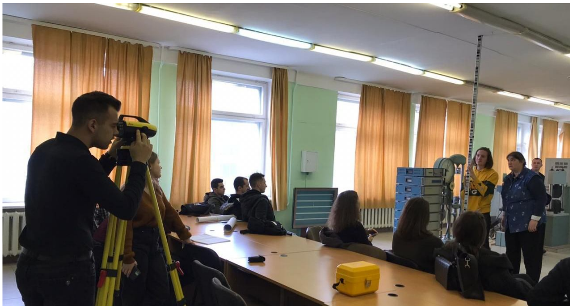
Рисунок 9 – Зняття показань нівеліра при завантаженні плити перекриття додатковим постійним навантаженням
