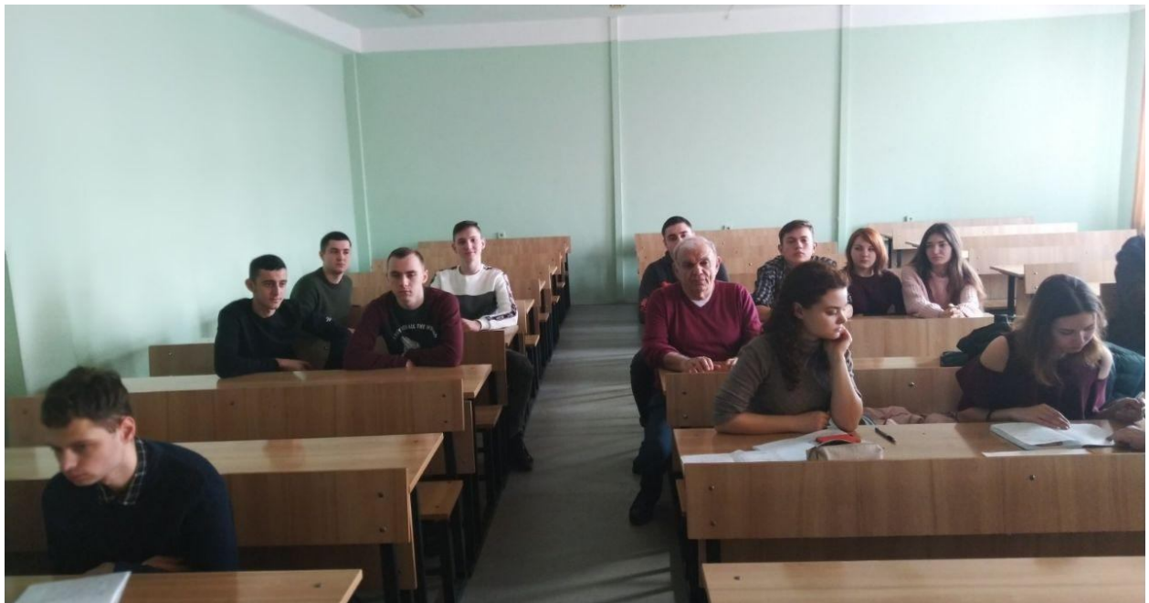
Рисунок 5 – Навантаження, на досліджувану плиту перекриття (4 людини на парту вздовж плити)
