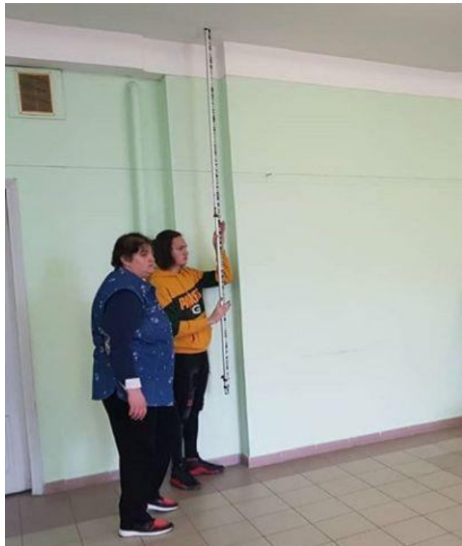
Рисунок 8 – Вимірювання початкових прогинів перекриття біля опори плити за допомогою нівелір
