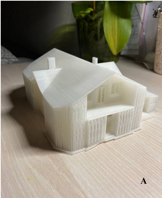
Рисунок 20 – Етапи зрізання підпірок з отриманої моделі макета будівлі : а – надрукований будинок; б – допоміжні з'єднувальні елементи; в) вирізання з'єднувальних елементів
