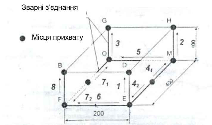
Рисунок 11– Ескіз металевої ванни з розмірами: (порядок накладення швів вказано великими цифрами; послідовність – маленькими цифрами; напрямок зварювання – стрілочкою)
