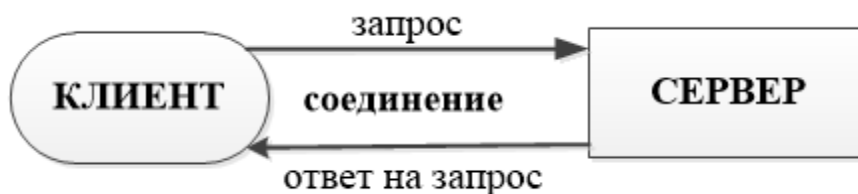
Рисунок 1.4 – Взаимодействие компьютера-сервера и компьютера-клиента
