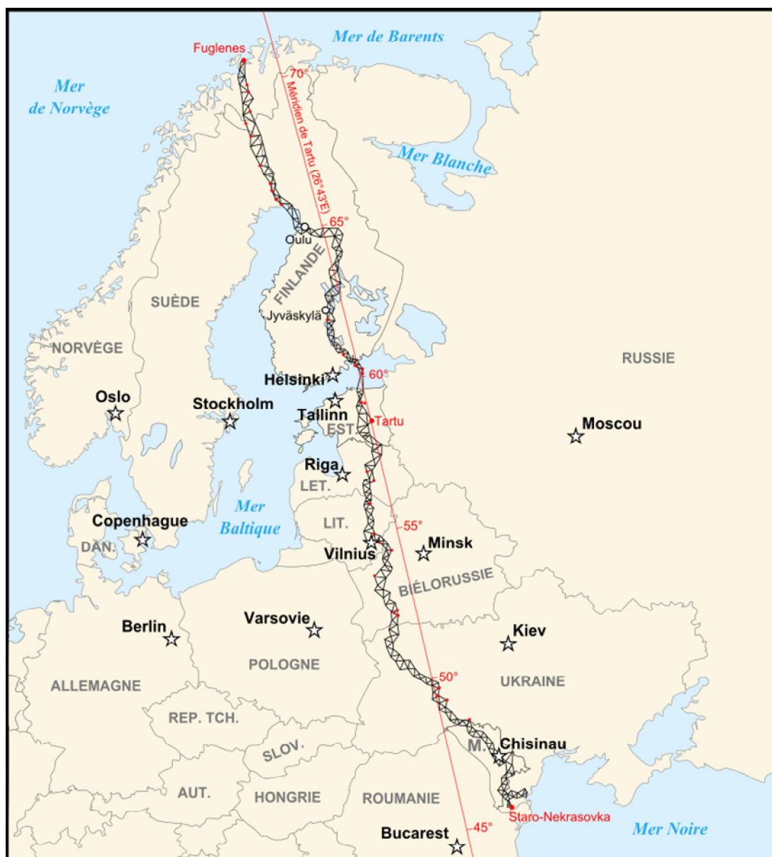
Рисунок 3.2 – Розміщення пунктів геодезичної дуги Струве
