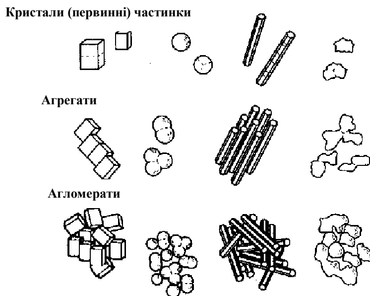
Рисунок 1.1 – Модель будови частинок пігменту згідно з DIN 53206–1
