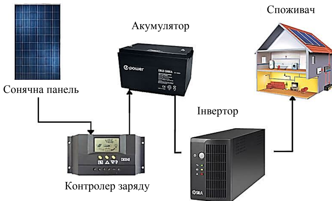
Рис. 1. Схема принципу роботи сонячної панелі
