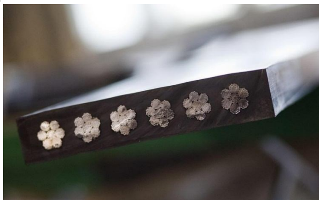
Рис. 1. Гнучкий тягово-несучий орган у вигляді гумотросового каната
