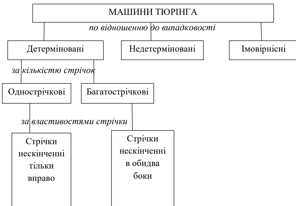
Рисунок 2.1 – Схема класифікації МТ
