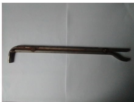
Рисунок 4 – Трубка Піто – Прандтля
