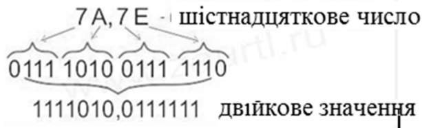
Рисунок 1.12 – Перетворення шістнадцяткового числа в двійкове
