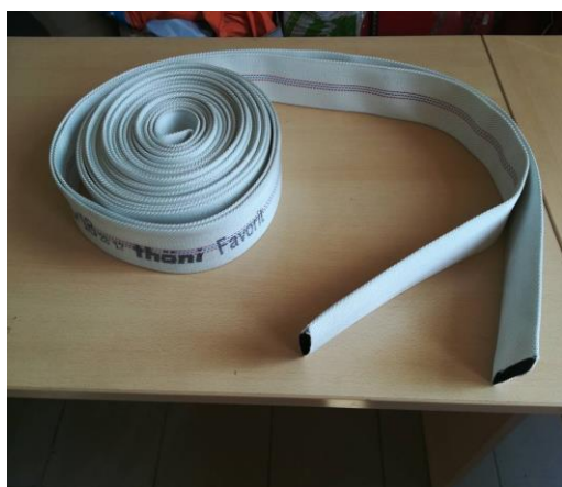
Рис. 1. Зовнішній вигляд скатки напірного пожежного рукава австрійського виробництва, який підлягав експериментальним дослідженням
